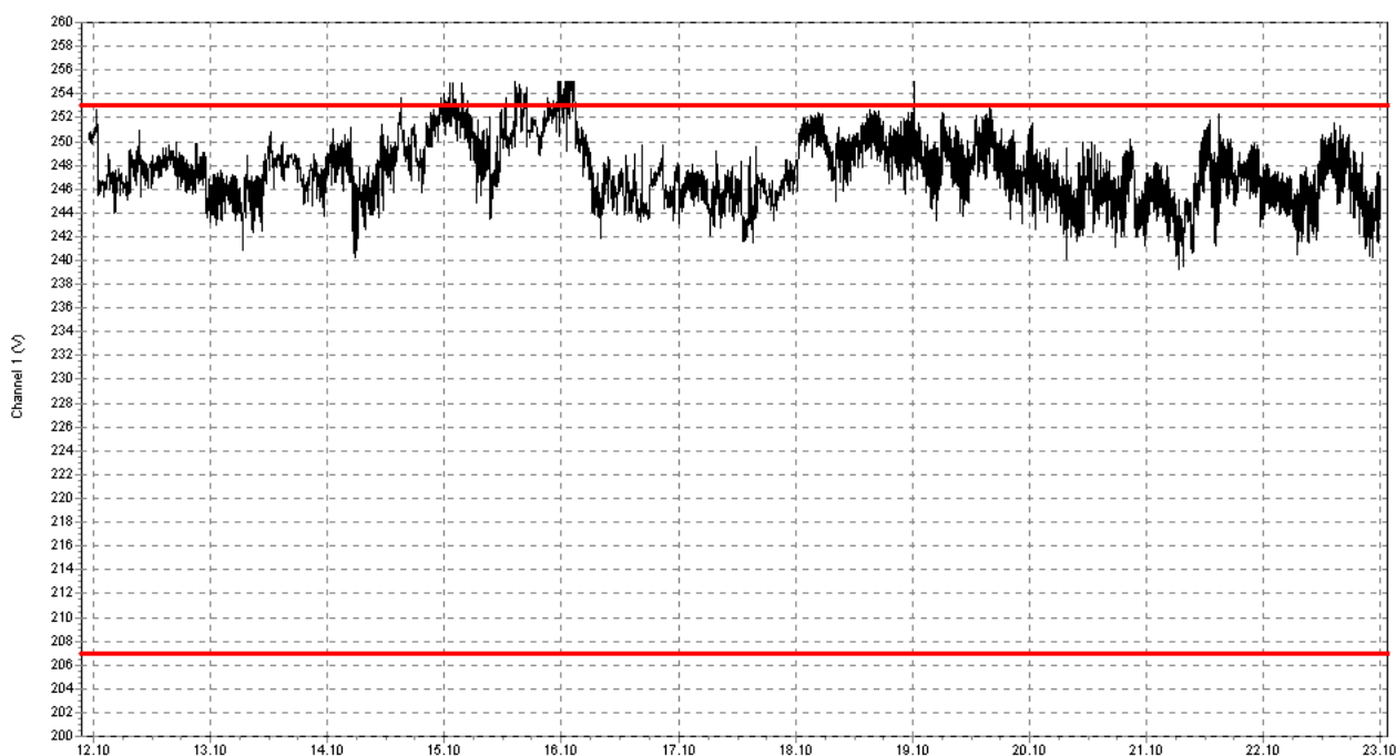
Figur 60 Målte spenningsvariasjoner i et tilfelle av havari på elektrisk utstyr på grunn av høye spenninger.
