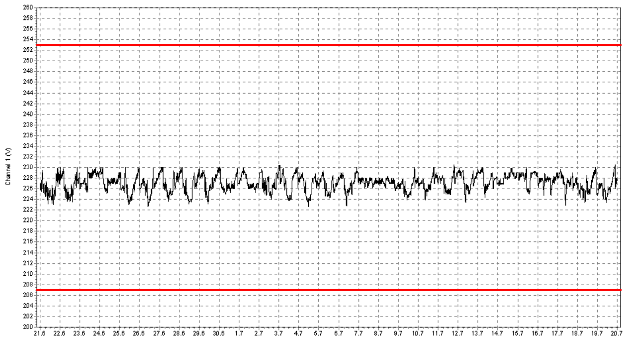
Figur 11. Et typisk eksempel på små spenningsvariasjoner i et relativt sterkt og kompakt kabelnett i en norsk by (målepunkt A).
