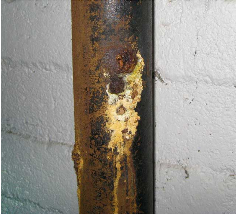
Figur 12. Eksempel på utvendige rustvorter [25]
