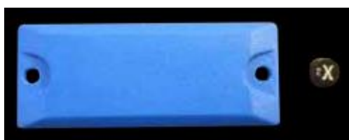
Figur 6-11 To eksempler på passive RFID brikker i ECOSAFE systemet
