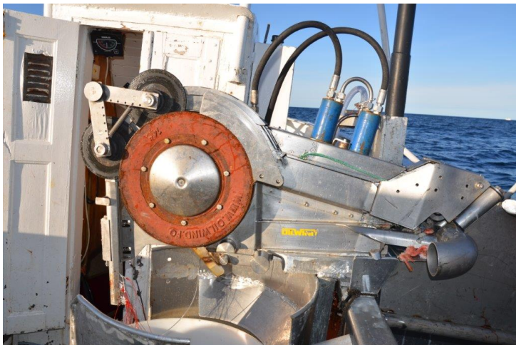
Figur 2-4 Linekveiler (rustrød skive) med presshjul (2 svarte hjul) og kniv på undersiden
