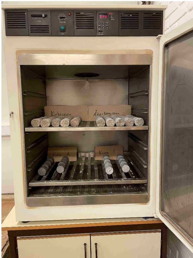
Figur 3.6. Prøvesylindre brukt til prøving av vannabsorpsjon, trykkfasthet og densitet
