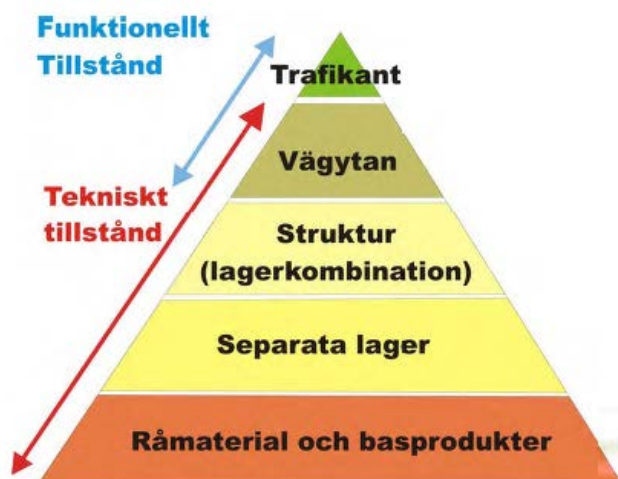
Figur 3-1: Sammenheng mellom funksjonell og teknisk tilstand [12].
