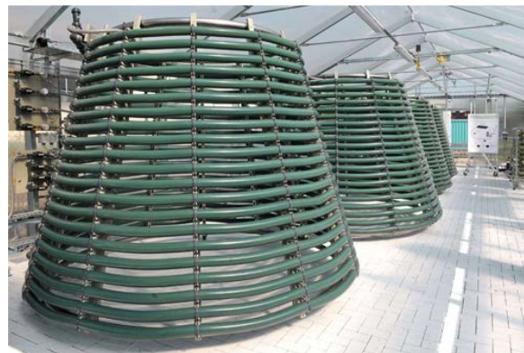
Figur 3-19 Et eksempel på at det investeres i FoU knyttet til mikroalgeproduksjon og oppskalering, "The GICON® Octagon photobioreactor, part of the EU-funded project Space@Sea". Reaktorene skal settes ut i sjøen.
