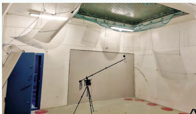
Klangrommet i hovedlaboratoriet. Prøveåpningen for vertikale konstruksjoner kan sees i bakkant. Denne åpningen lukkes ved absorpsjonsmålinger. Prøveåpningen for horisontale konstruksjoner kan sees i himlingen.
