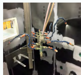
Bilde 2. Påføring av varmt og kaldt vann i testriggen
