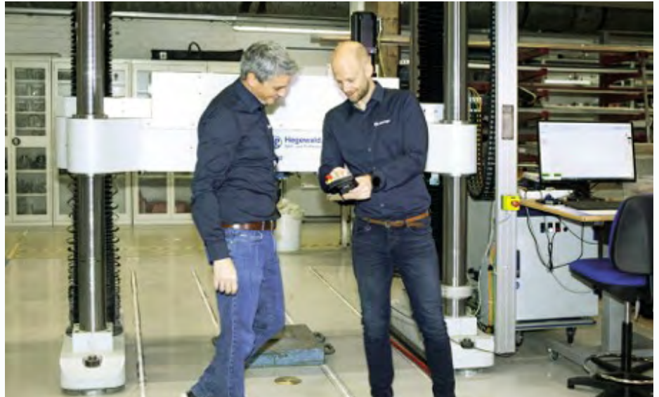
Laboratorieleder Jørgen Tidemann-Andersen og rådgiver Jan-Fredrik Aasheim foran universalprøvemaskin med kapasitet på 300 kN i strekk og trykk. Denne er egnet til å prøve en stor variasjon av stillaskomponenter. Foto: SINTEF
