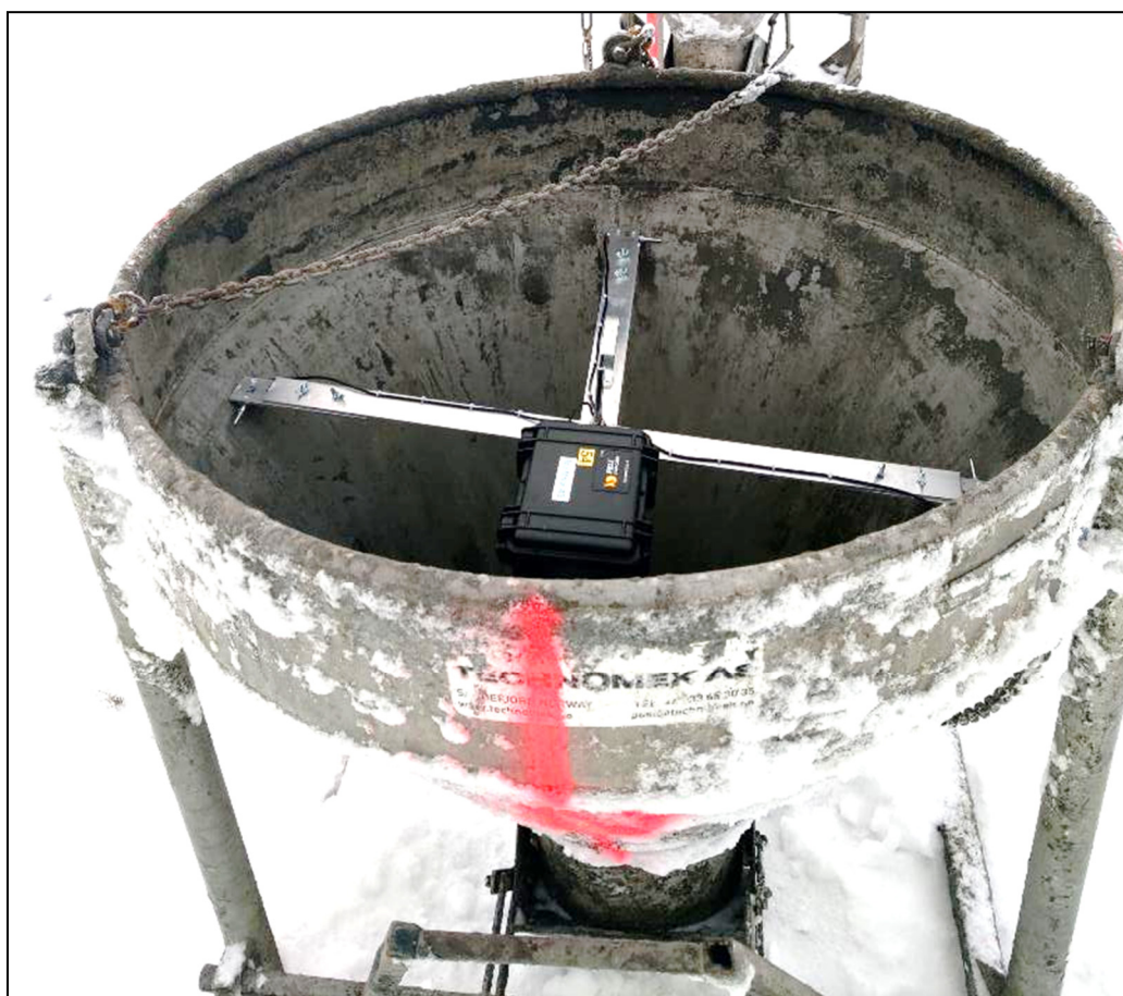
Figur 22: SINTEF Narviks sensorkryss plassert i en tom standardtobbe fra Technomek AS. Her vises de fire overflatesensorene og luftsensoren. Boksen inneholder logger, sender og GPS og sender i sanntid.
