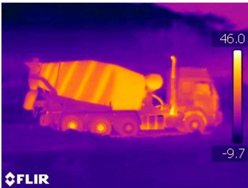
Figur 3: IR-fotografi av Magnar Solvangs bil som vaskes med varmt vann etter fullført leveranse i forbindelse med helikoptertransport av betong på Altevann 8.12.2020. Fargespekter i høyre kant representerer temperatur målt i °C.
