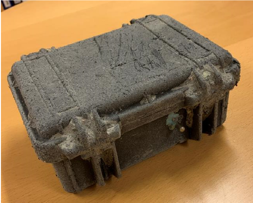
Figur 2: Trommellogger etter ett års bruk. De fungerer fremdeles. Utstikkende sensor ses midt i bildet.
