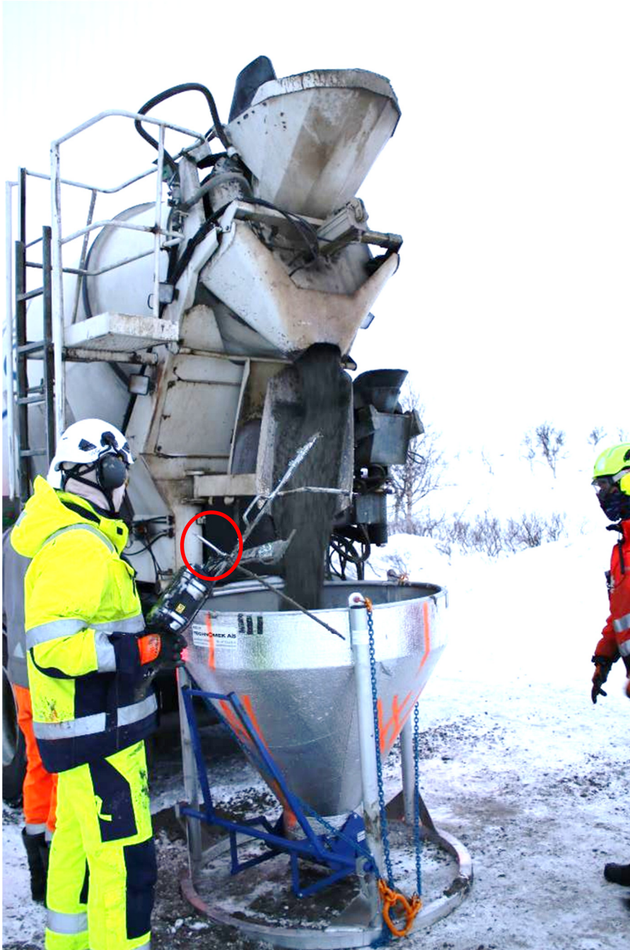
Figur 36: Vintertobbe fylles, og SINTEF Narviks representant står klar med målekrysset. Lufttemperatursensoren markert i rød sirkel. 16.12.2020
