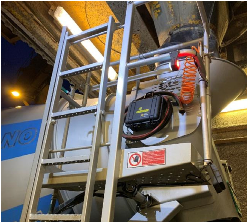
Figur 1: Lufttemperatur- og GPS-logger montert på en av bilene til Thore Magnussen og Sønn, i forbindelse med betongtransport for B&E. Foto: https://www.magnussenogsonn.no/
