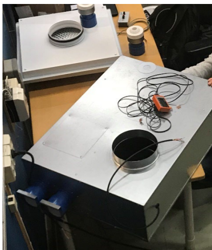
Figur 3-2. Bildet viser et plenumkammer brukt i prototype 1 før det ble installert i første forsøksrunde.
