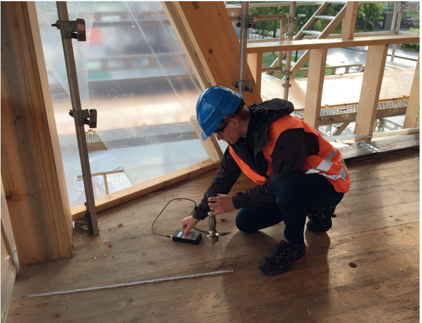
Fuktmåling i ZEB-laboratoriet.
