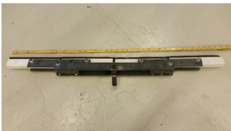
Fig. 3. Leddet lastpåføringsbjelke ved prøving av Metode B .
