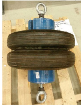
Fig. 4. Pendel til pendelprøving av Metode C .
