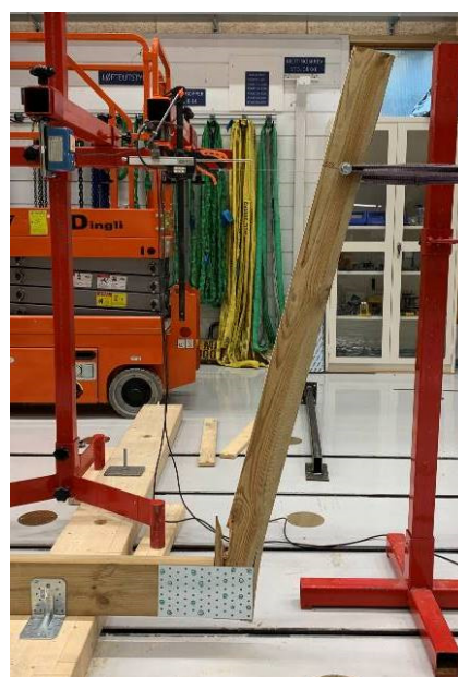
Figur 62 Test 40 ved bruddlast
