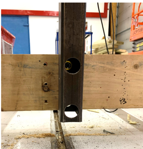
Figur 53 Prøveoppstilling M. Stolpe festet med bare to skruer i midten av fotplaten
