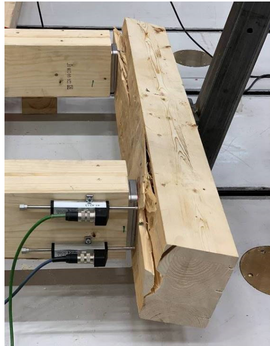
Figur 60 Test 39 ved bruddlast
