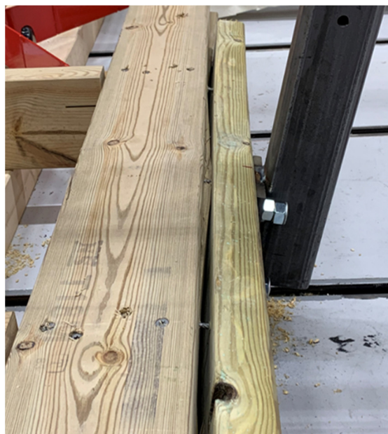
Figur 35 Topplanke sprekker ved bruddlast.
