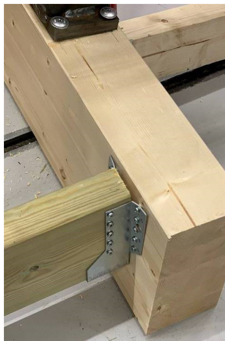
Figur 30 Deformasjon av beslag og uttrekk av skruer
