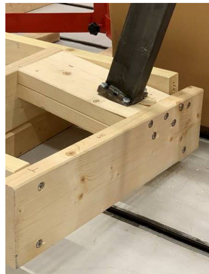
Figur 66 Test 42, ved bruddlast på 3,3 kN
