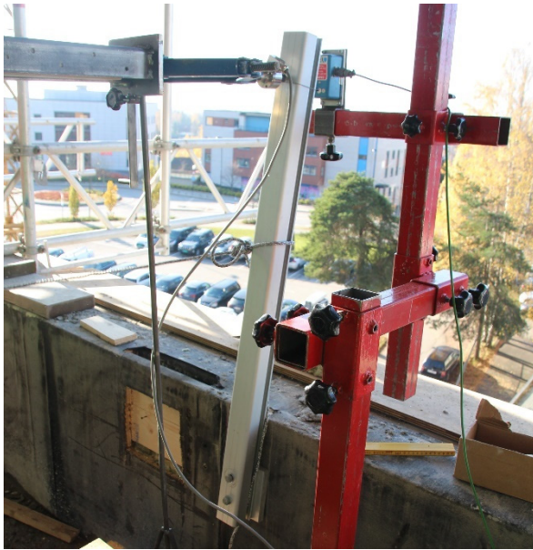
Figur 8 Eksempel på feltprøving av glassrekkverksstolpe montert til parapet. Stolpen hadde på forhånd bestått laboratorieprøving, men trekonstruksjonen den var festet i var ikke tilstrekkelig dimensjonert for den horisontale linjelasten. På bildet er lasten ca. 1,0 kN og deformasjonen ca. 95 mm. Foto: SINTEF
