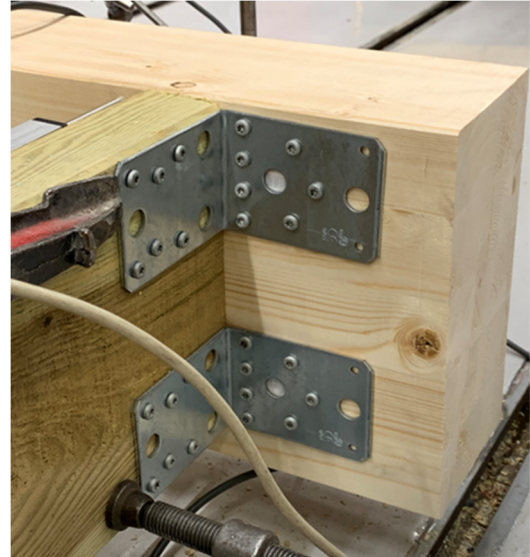
Figur 39 Prøveoppstilling H, test 16 med vinkelbeslag
