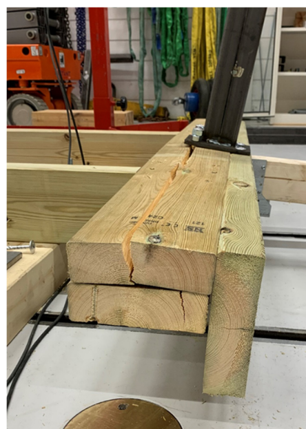
Figur 33 Topplanke og kubbing sprekker.
