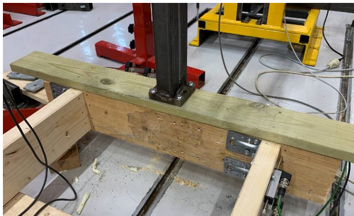
Figur 50 Prøveoppstilling L, test 34. Toppmontert stolpe på terrassebord
