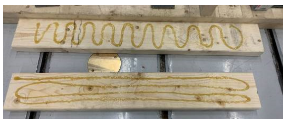
Figur 48 Prøveoppstilling K, test 36. Liming av forkantplanker
