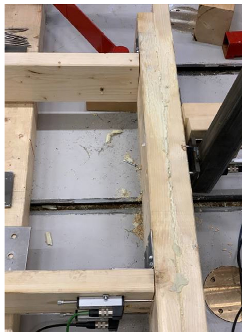
Figur 49 Prøveoppstilling K, test 36, ved bruddlast
