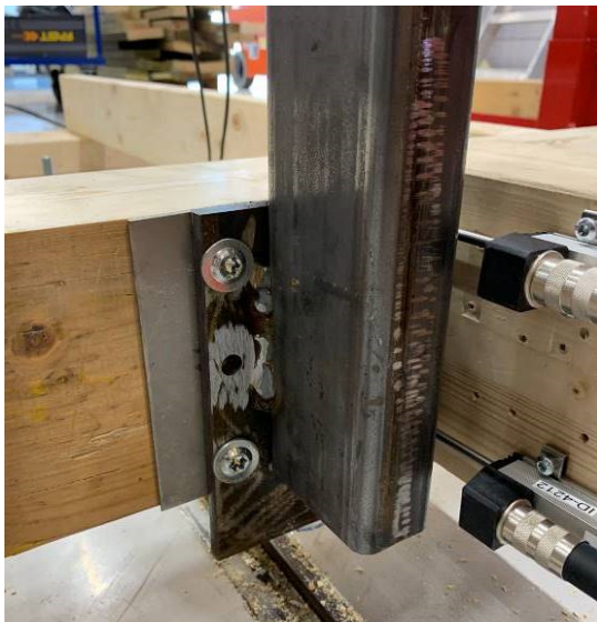
Figur 44 Test 27 med lastfordelingsplate
