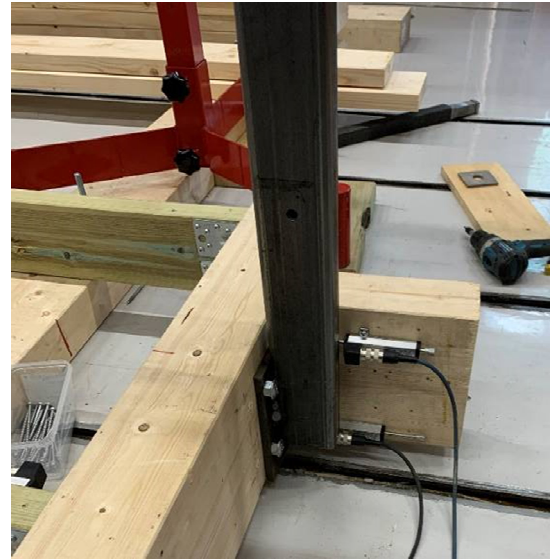
Figur 43 Test 20. Pos. givere mot stolpefot
