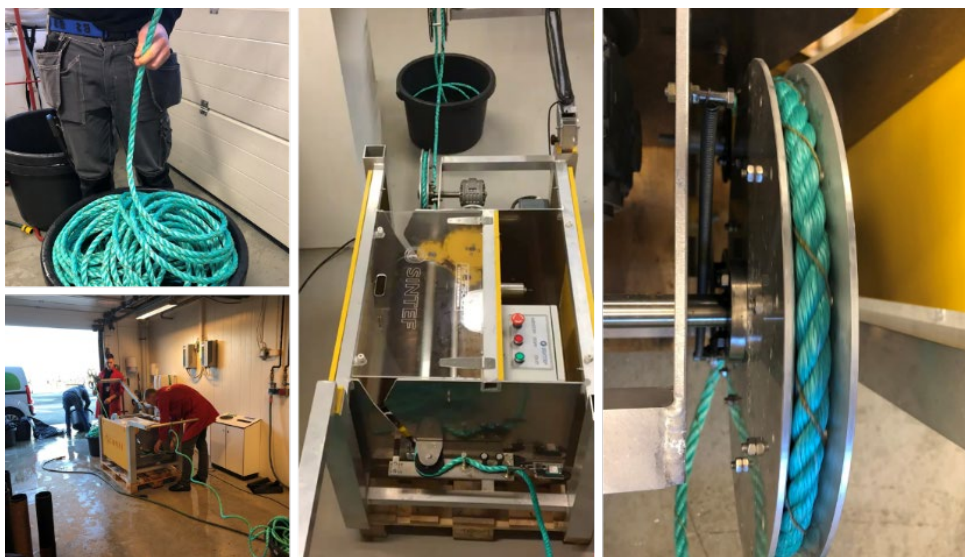
Figur 16. Spinning av taretau. Den tynne tarelinen (1.2 mm) ble tvunnet over på et kraftigere tau (16 mm) i en "spinnemaskin", utviklet av SINTEF Ocean og prototype bygd av M-TECH. Etter spinning ble tauene fraktet i stamper til Kristiansund, der stamperne ble fylt med sjøvann og oppbevart kjølig i 4 dager før utsettingen (Foto: SINTEF).
