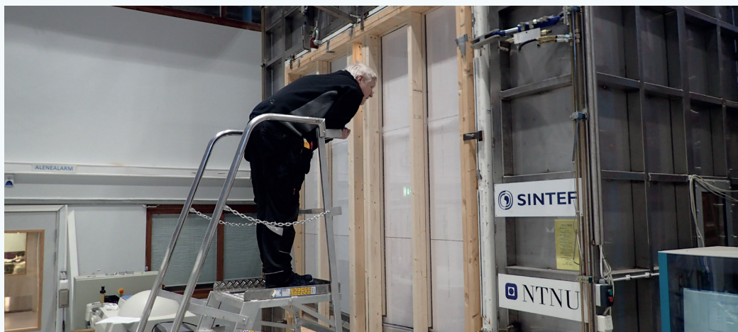
Inspeksjon av vassinntrenging bak fasadekledning under regnprøving. Vindsperra er gjennomiktig slik at vi enkelt kan observere når og korleis vatn kjem inn gjennom dei horisontale fugene i platekledninga.
