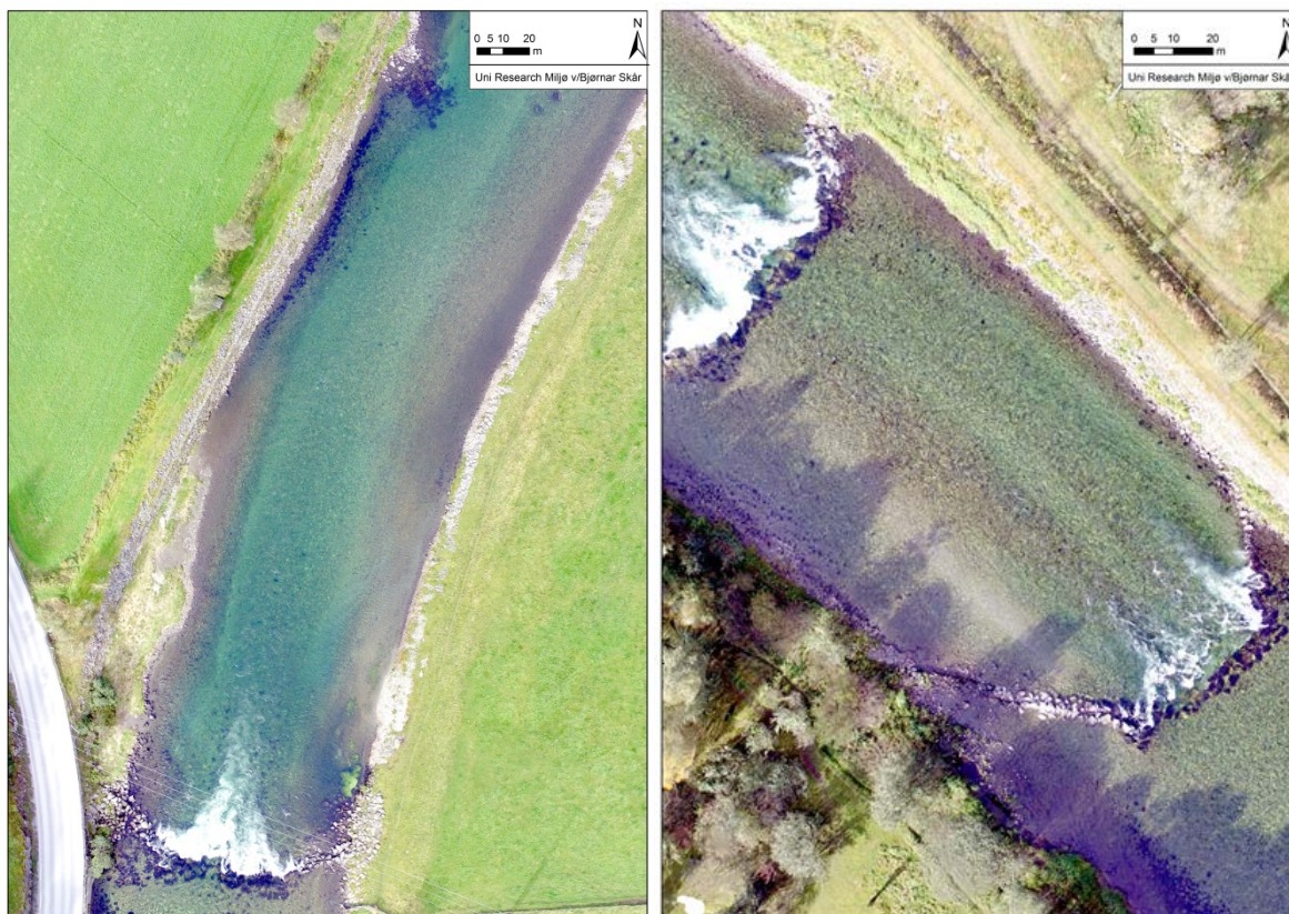
Figur 31: Dronebilde som viser sedimentering i terskelbasseng.
