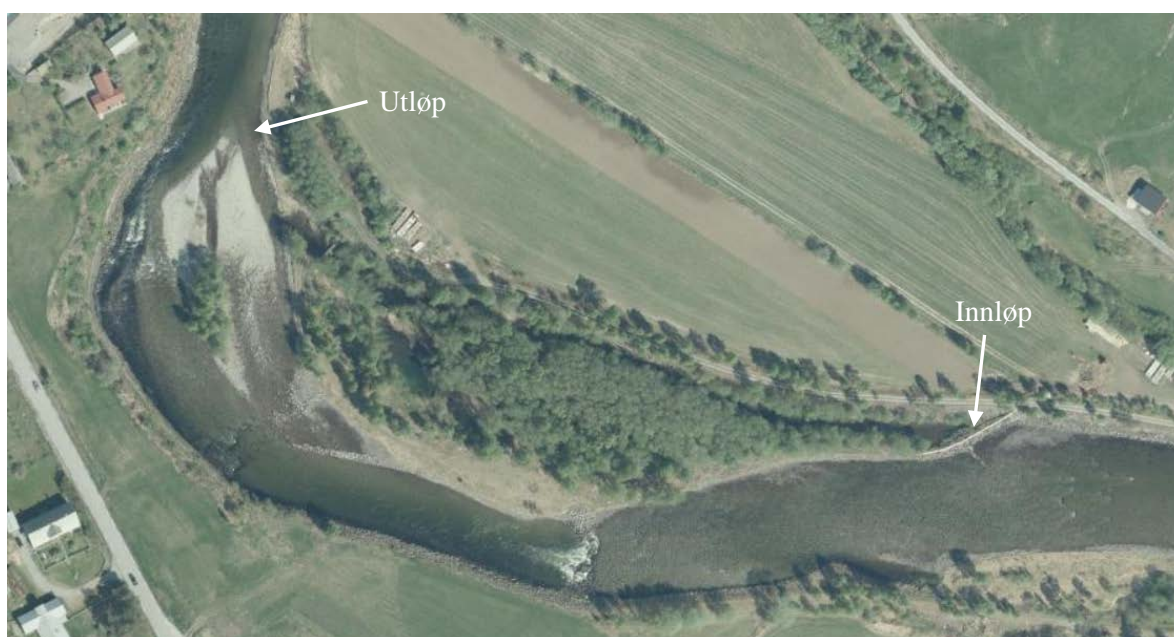
Figur 58: Kile 10, Tønjumskvitli bør justeres i innløpet for å sørge for årssikker vannføring.
