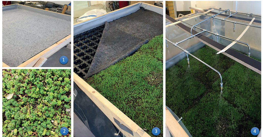
Lab forsøk for måling av avrenningskoeffisienter fra grønne tak. 1: Trekasse for testing av ulike materiallag. 2: Sedumvegetasjon for grønne tak. 3: Lagvis oppbygning av et av de grønne takene. 4: Sprinkelsystem som simulerer nedbørshendelser. Foto: Lotte Askeland Schärer
