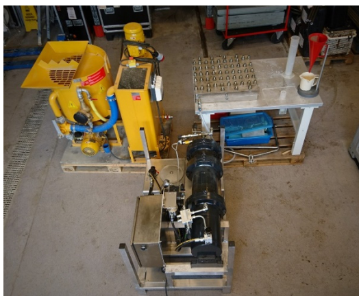
Figur 49: Kolloidalmikser og spesialkonstruert pumpe for injeksjon av laboratoriemodell
