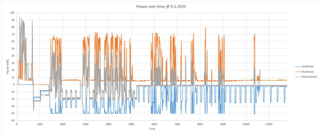
Figur 15. Driftsprofil med batteri og kabel for ZERON ZE160LC Peakshaver+. Kilde: NASTA.
