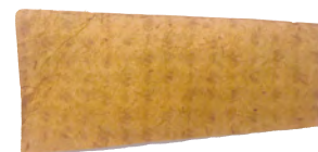
Eldre vindsperre, trolig fra 1936. Kraftpapp med vaffelpresset mønster.
