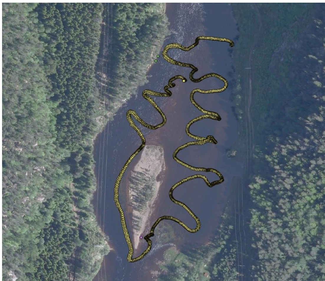
Figur 20. Innmålt trase for ekkoloddmålinger på strekning 5 ved øya Sanøy. De grunne områdene vises på østsiden av øya og nordover.
