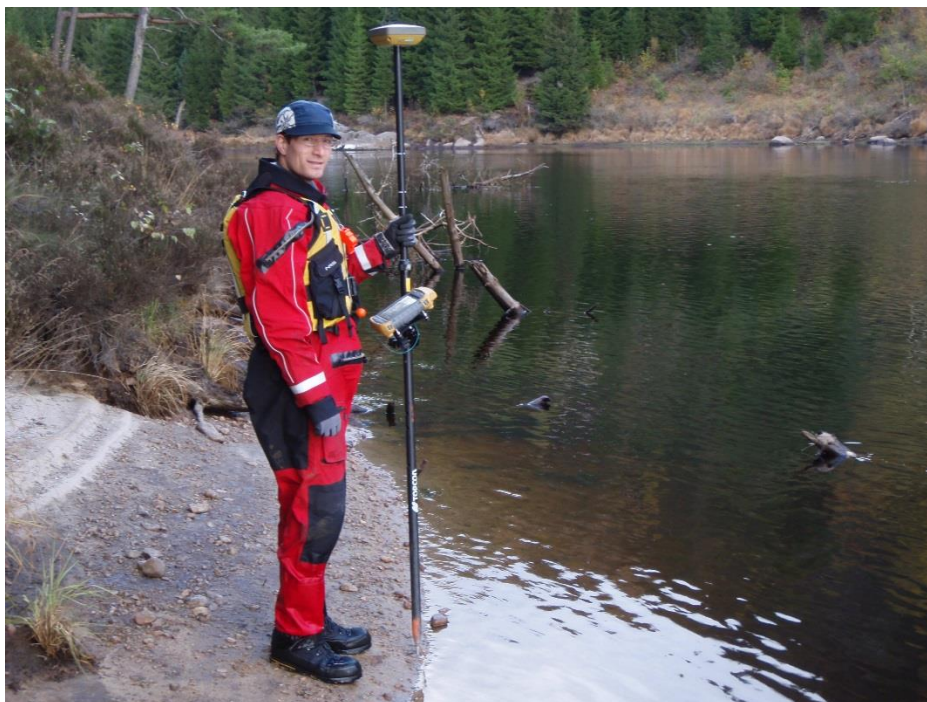
Figur 5. Innmåling av elvebredd og vannivå med differensiell GPS ved strekning 5 ved Sanøy.
