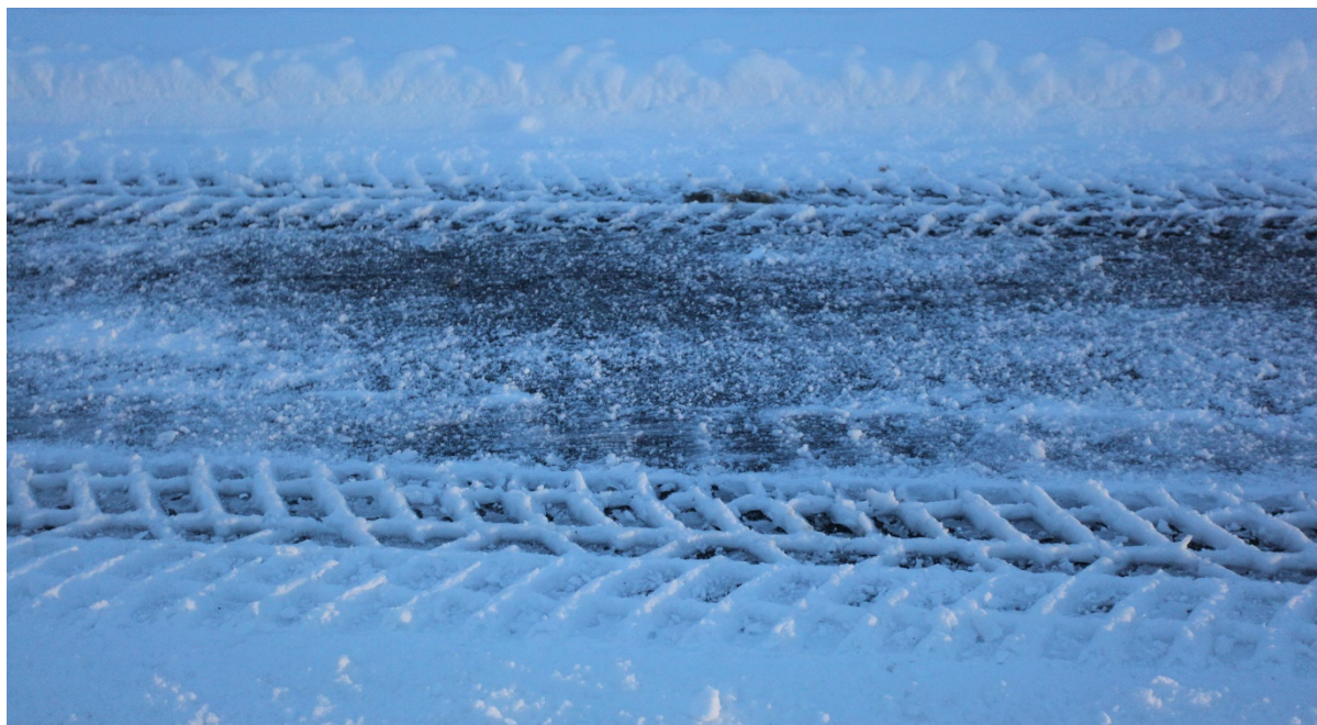
Figur 11: 20 km/t 7 cm saltblandet snø. Her vises det at en høyere hastighet gir et dårligere resultat. Det er også tydelig at kosten har problem med å effektivt fjerne snøen i ytterkantene.
