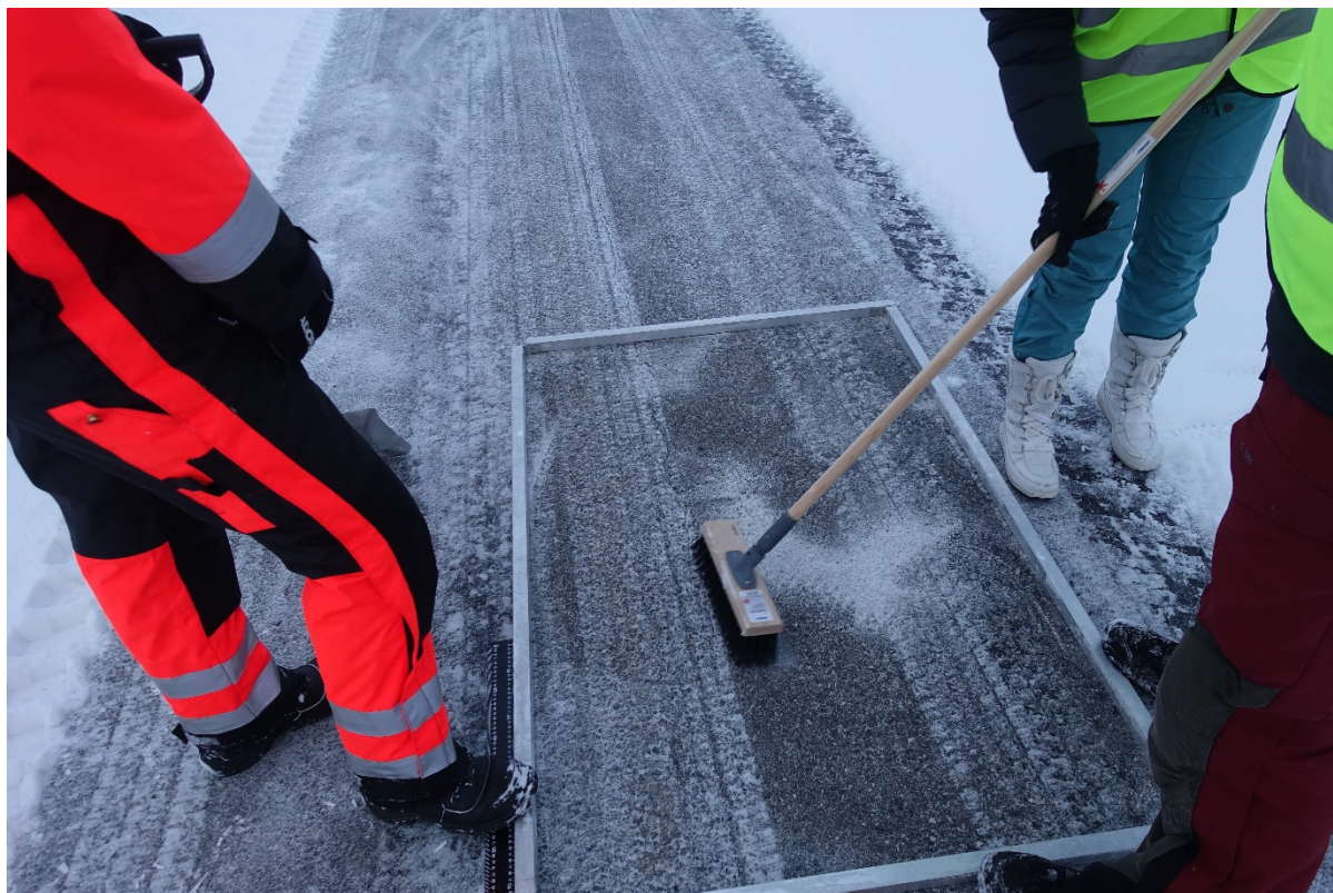
Figur 15: 10 km/t tørrsnø. Det er svært lite forskjellen mellom 5 km/t og 10 km/t, ved slike forhold vil ikke farten være avgjørende for resultatet.
