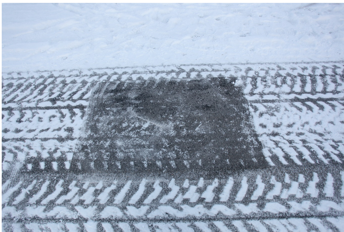
Figur 22: Kjørehastighet 5 km/t komprimert tørrsnø. Resultat etter forsøk med økt rotasjonshastighet på kost.
