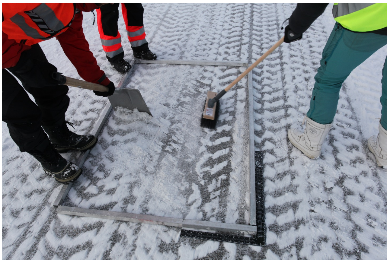
Figur 5: Illustrasjon av oppsamlingsmetode og definering av testareal.
