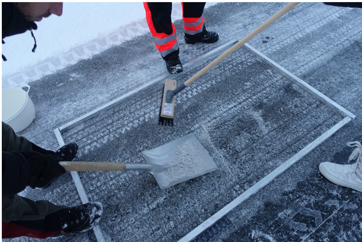
Figur 14: 5 km/t tørrsnø. Ved slike forhold gir kosten gode forhold med lite snø igjen og god opplevd friksjon for myke trafikanter.
