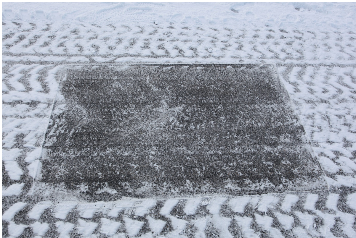
Figur 20: 10 km/t komprimert snø: Her vises resultatet av kostingen rundt, samt hvor mye snø det var mulig å fjerne før veiing i midten.
