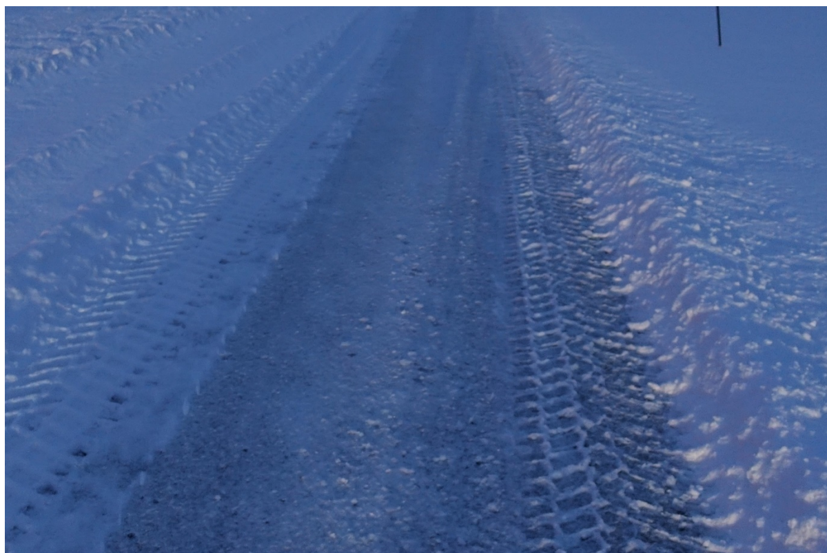
Figur 12: 5 km/t 9 cm saltblandet snø. Her vises det igjen at kosten får problem å rydde snø i hele bredden. I tillegg er det mye snø igjen etter tiltak.
