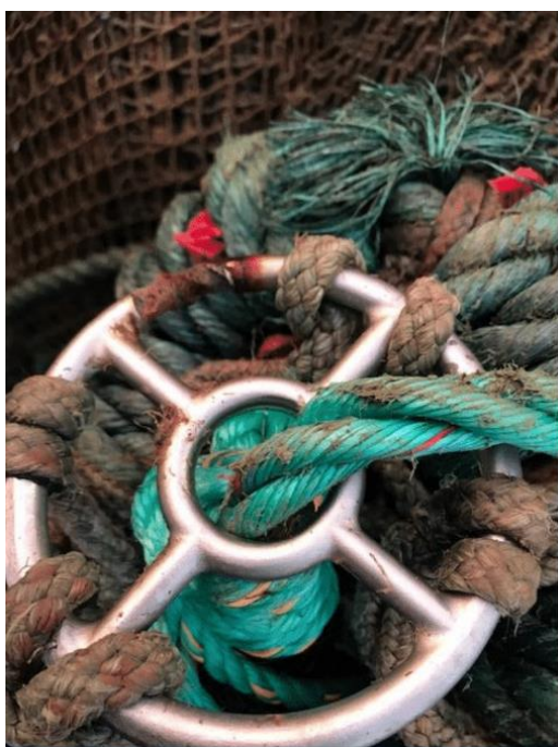
Figur 13: Senterringer i not med korrosjonsskader.
