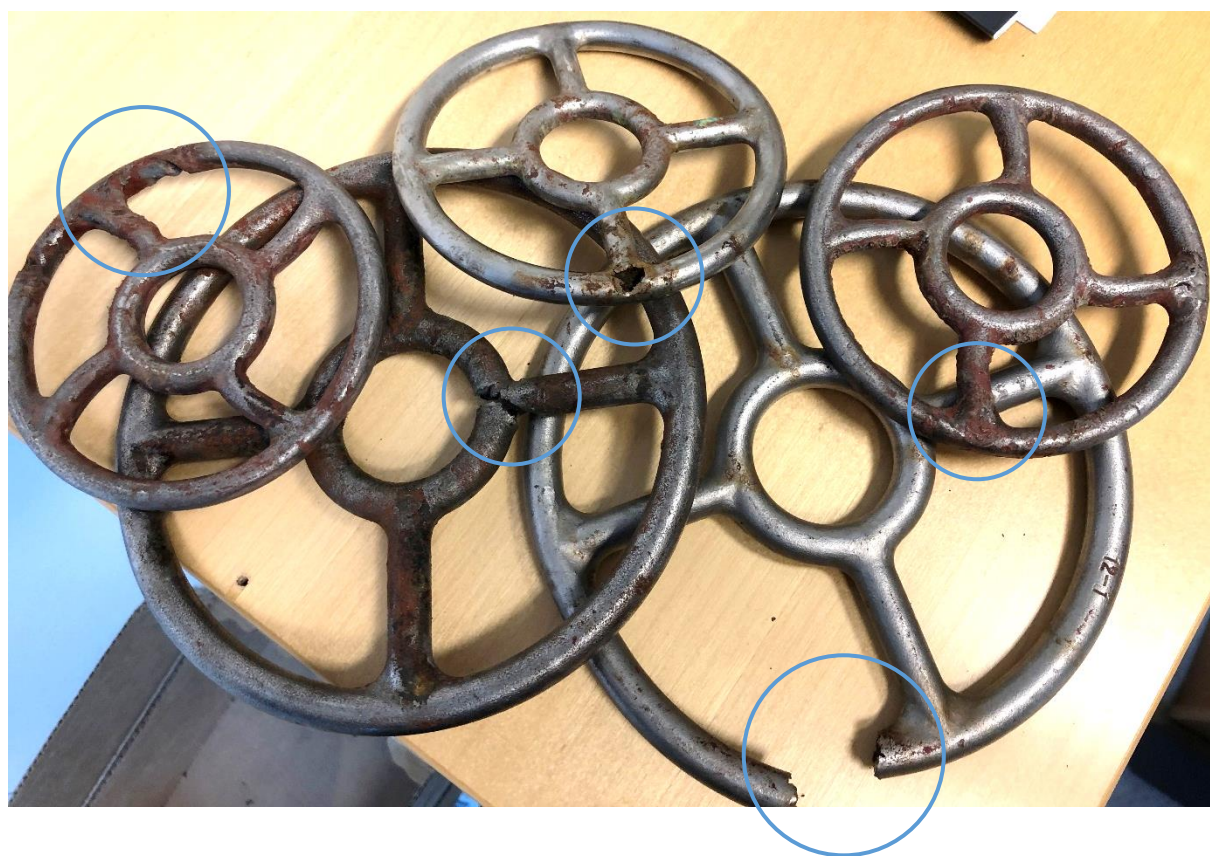
Figur 14: Senterringer og ringer til loddssystem med korrosjonsskader.
