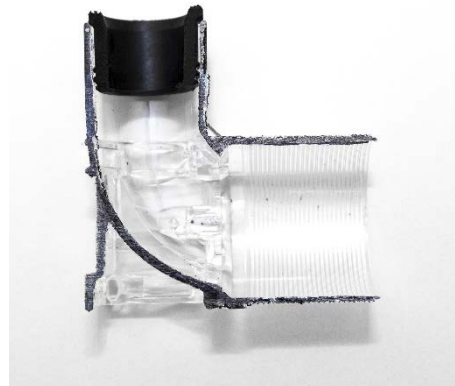
Figur 28 Snitt veggboks, leverandør B (tverrsnitt malt i sort for foto)
