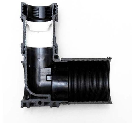
Figur 30 Snitt veggboks, leverandør C
