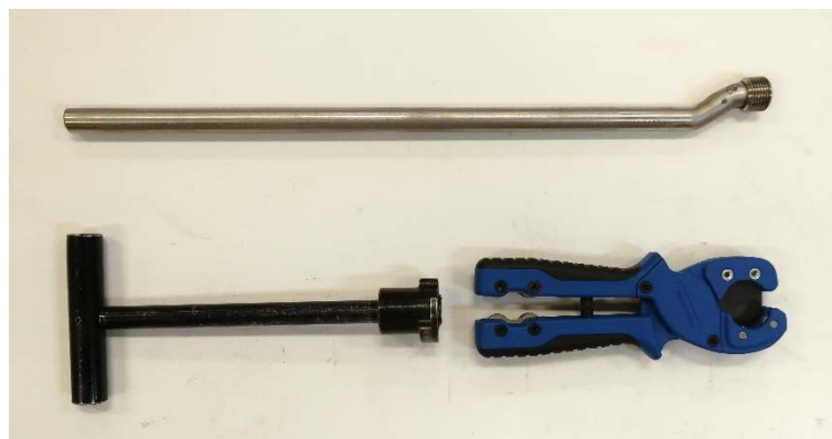
Figur 32 Verktøy for montering og testing; gjengestang, leddet uttrekksverktøy og rørkutter
