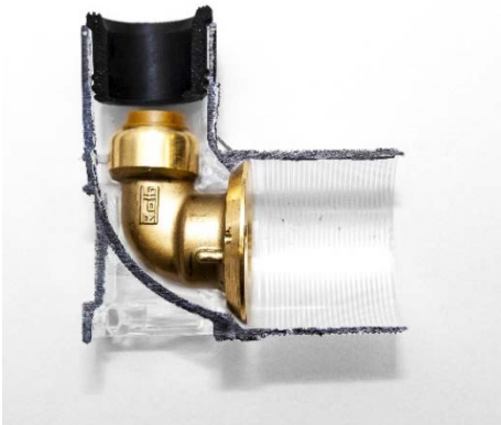
Figur 27 Veggboks med albue, leverandør B (tverrsnitt malt i sort for foto)
