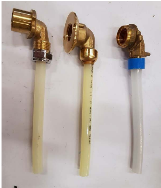
Figur 23 Albue med PEX-rør. Fra venstre leverandør A, B og C
