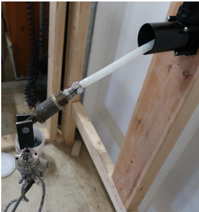
Figur 19 Kraftmåler kobles til rørenden, og måleprogrammet nullstilles.
