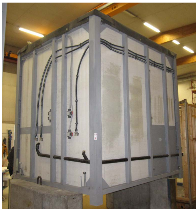
Figur 10 Eksempel på føring gjennom stålstendere til veggboкс
