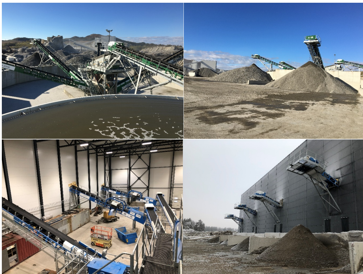
Fig. 1 Produksjon av resirkulert tilslag ved våtprosess hos Velde AS i Rogaland (bilder øverst) og hos AF Gruppen i Nes Miljøpark i Akershus.
