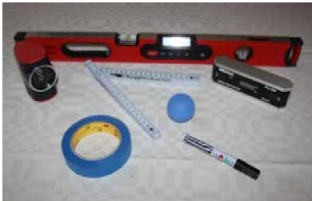
Figur 5: Med laser, vater, kule, tommestokk kan fallforhold nøyaktig kontrolleres.
