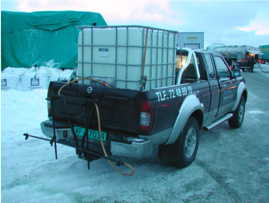
Figur 2.8: Rigg for utspredning av ICE-AWAY
