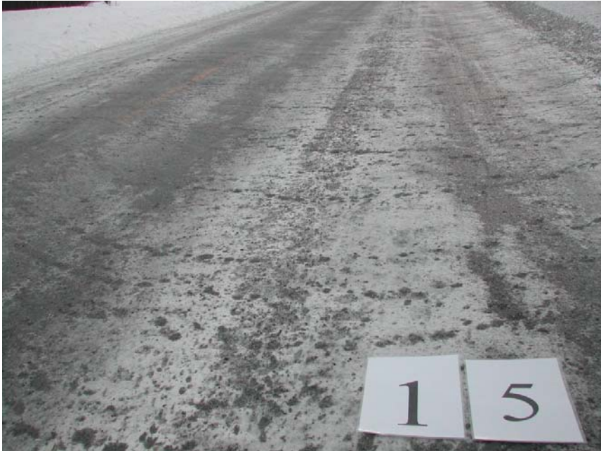
Figur 3.15: Epoke. Strøresultat på veg
