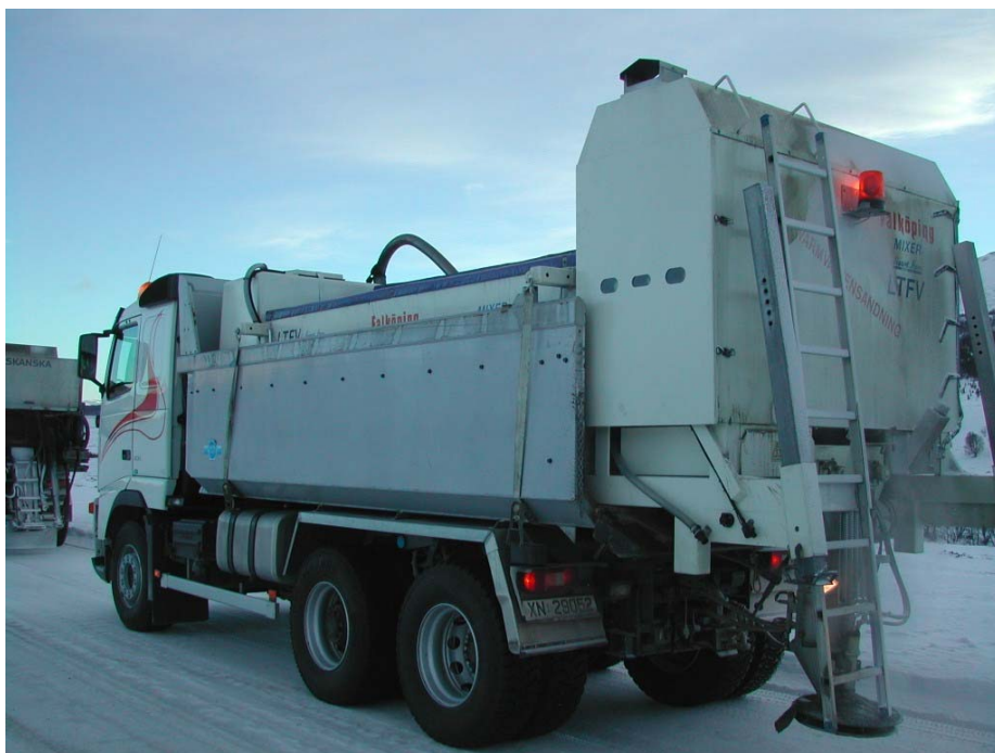
Figur 2.6: Fastsandspreder levert av Falköping til sesongen 2004/2005, Kolo Veidekke Oppdal
