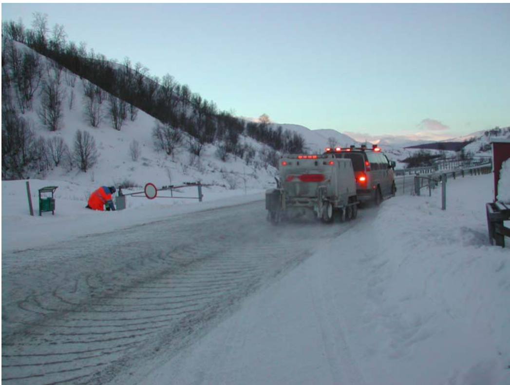
Figur 2.27: Friksjonsmåling med Roar Mark III
