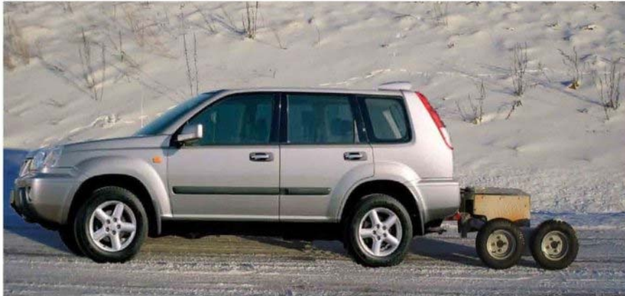
Figur 3.59: Friksjonsmåler som ble benyttet under testene 3. – 4. februar
