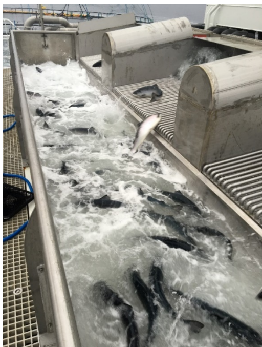
Figur 12 – Posisjon 2 : Etter å ha passert avlusingsenhetene og de hydrauliske fiskepumpene (Hydrolicer LG9332 Hydro) passerer fisken en silke plassert foran en vannfylt renne (venstre bilde) med fall der fisken ledes passivt ut i merd for avluset fisk. Høyre bilde viser ett av to kar, plassert ved siden av silkassen/rennen, som fisk ble håvet enkeltvis til for analyse (stress, velferd og lustelling).
