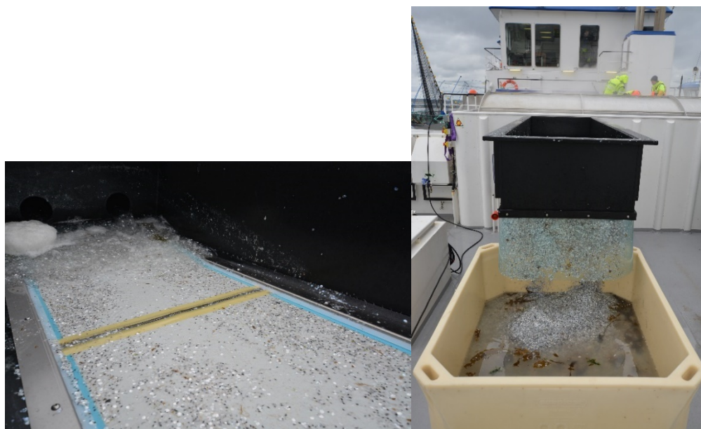
Figur 21 – Oppsamling av partikulært materiale fra filterene (80 \mu\text{m} ) som prosessvannet fra avlusingen passerer gjennom før utslipp til sjø. Bildet til venstre viser transportbåndet som transporterer hovedsakelig skjell og lus fra filteret til oppsamlingskassen vist til høyre.
