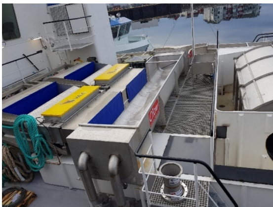
Figur 20 – Utløpssiden på Hydrolicer LH2245 Hydroflow. Fisken telles etter pumping (doble ejetorpumper) med Vaki fisketellere (gule lokk) før avluset laks kommer ut i rennen fylt med vann for overføring til merd. Posisjon 2: Fisk for lustelling, evaluering av stress og velferdsscore ble håvet ut på utløpssiden og overført til kar plassert ved rennen (høyre bilde).
