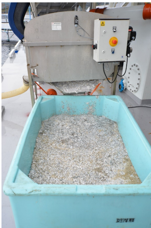
Figur 15 – Oppsamling av biologisk materiale (hovedsakelig skjell og lus) etter filtrering av avløpsvann fra Hydrolicer LG9332 Hydro.
