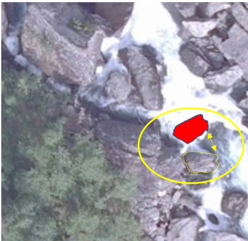
Figur 13. Ved utgangen av fisketrappa i Øverfossen har en steinblokk flyttet seg nedover. Det gule omrisset indikerer plasseringen i 2008, mens den røde figuren viser plasseringen i 2016 (og i dag).
