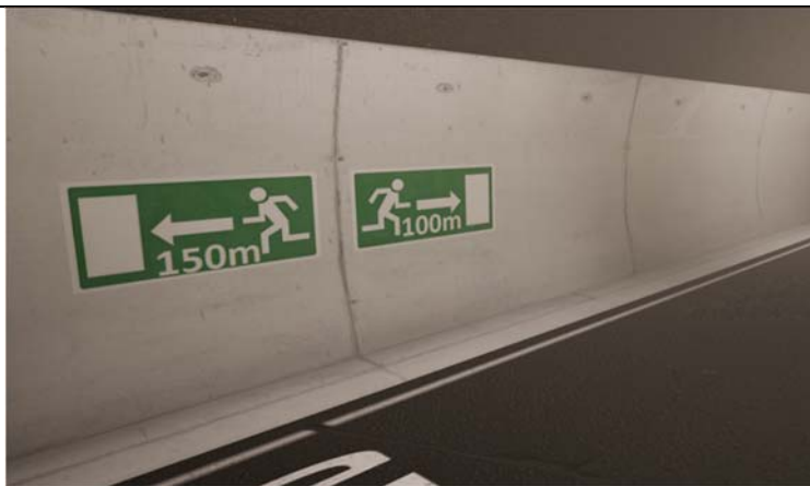
Figur 10 Avstandsskilt er plassert hver 50m. Skilt for begge retninger på begge sider av tunnelen er synlig for trafikant i startposisjon. Merk! skilt i startposisjon viser 100m mot og 150m vekk fra brannen i scenario 1-5. I scenario 6 er tilsvarende visning 50m og 450m. Skjermdump fra VR modell. For nærmere beskrivelse av scenarier se pkt 2.7
