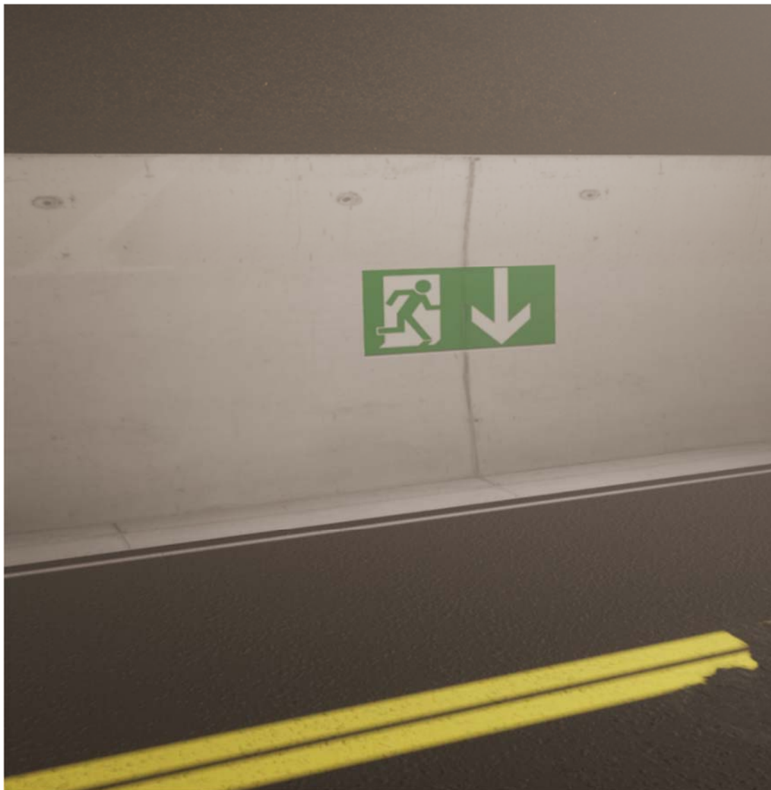
Figur 13. Dynamisk plassert pil-ned skilt på motsatt side av tunnelen for dynamisk plassert dør til redningsrom (ikke benyttet i scenario 1-3). Skjermdump fra VR modell.
