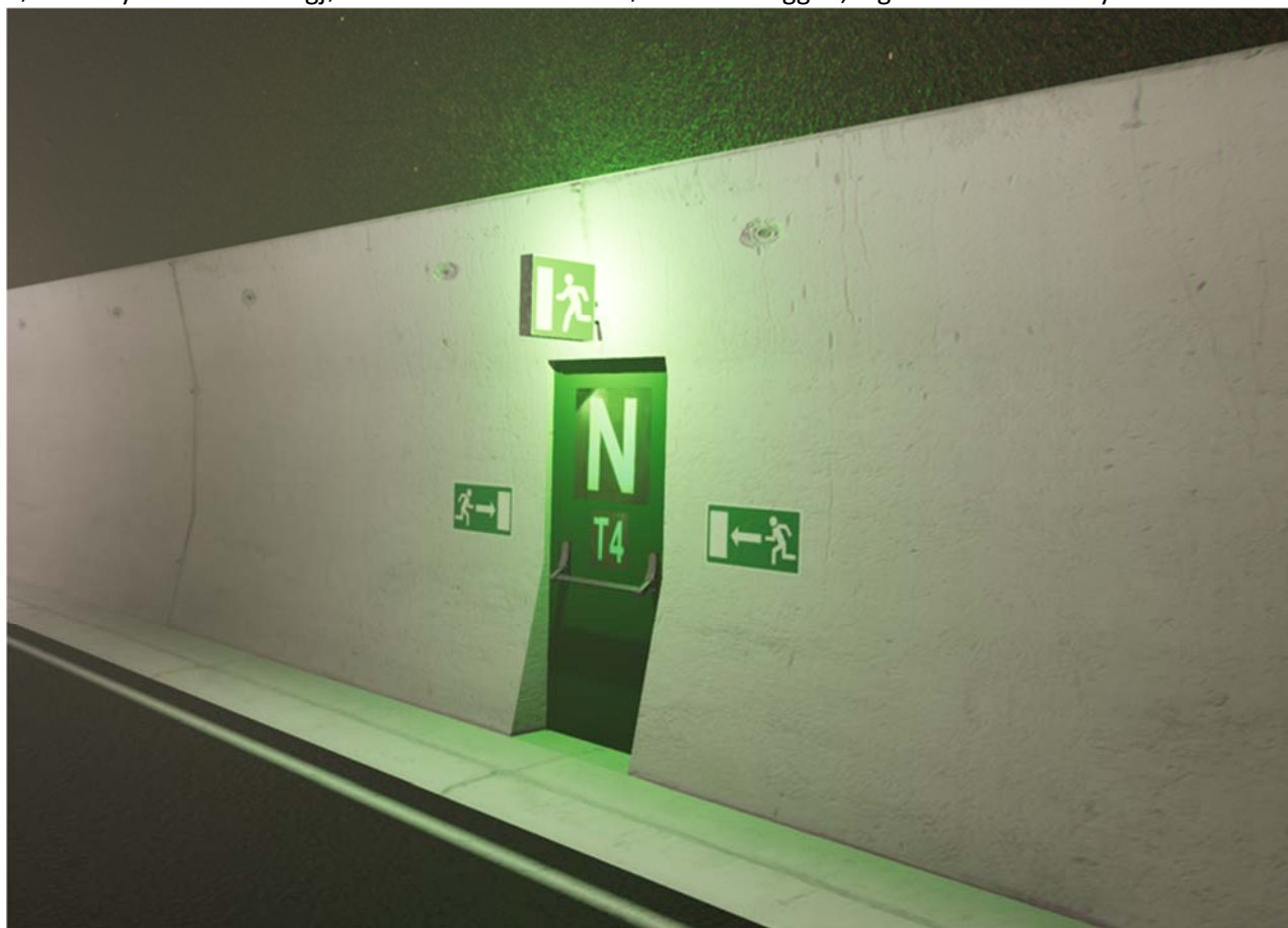
Figur 12. Basisscenarioet har en enkel utforming av dør til redningsrom uten visuell forsterkning eller akustisk ledesystem. Betingelser: 250m avstand mellom redningsrom og 1m sikt i røyk. Skjermdump fra VR-modell.
