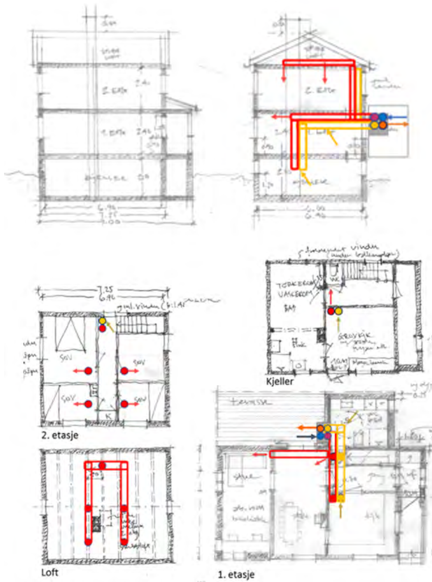
Forslag til montering av balansert ventilasjonsanlegg.
