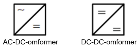
Figur 5.4. Generelle symboler for AC-DC- og DC-DC-omformere
