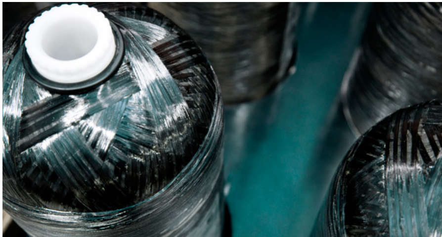
Figur 4.12. Synlige glassfibertråder i yterste del av komposittanker. Kilde: Hexagon [59]
