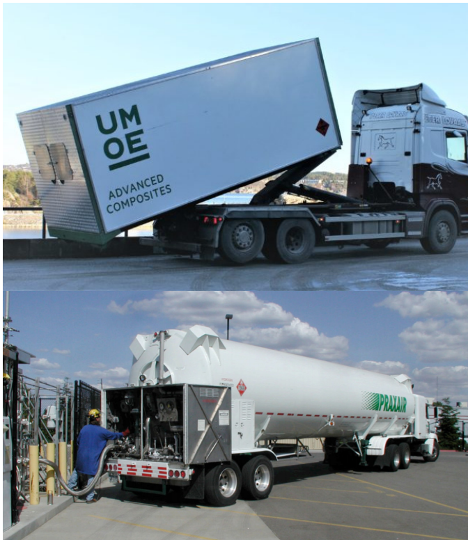
Figur 4.16. Transport av hydrogen. Til venstre, UMOE [69]: i komprimert form med trykk tanker i en container. Til høyre: flytende hydrogen på tankbil, PraxAir [70]
