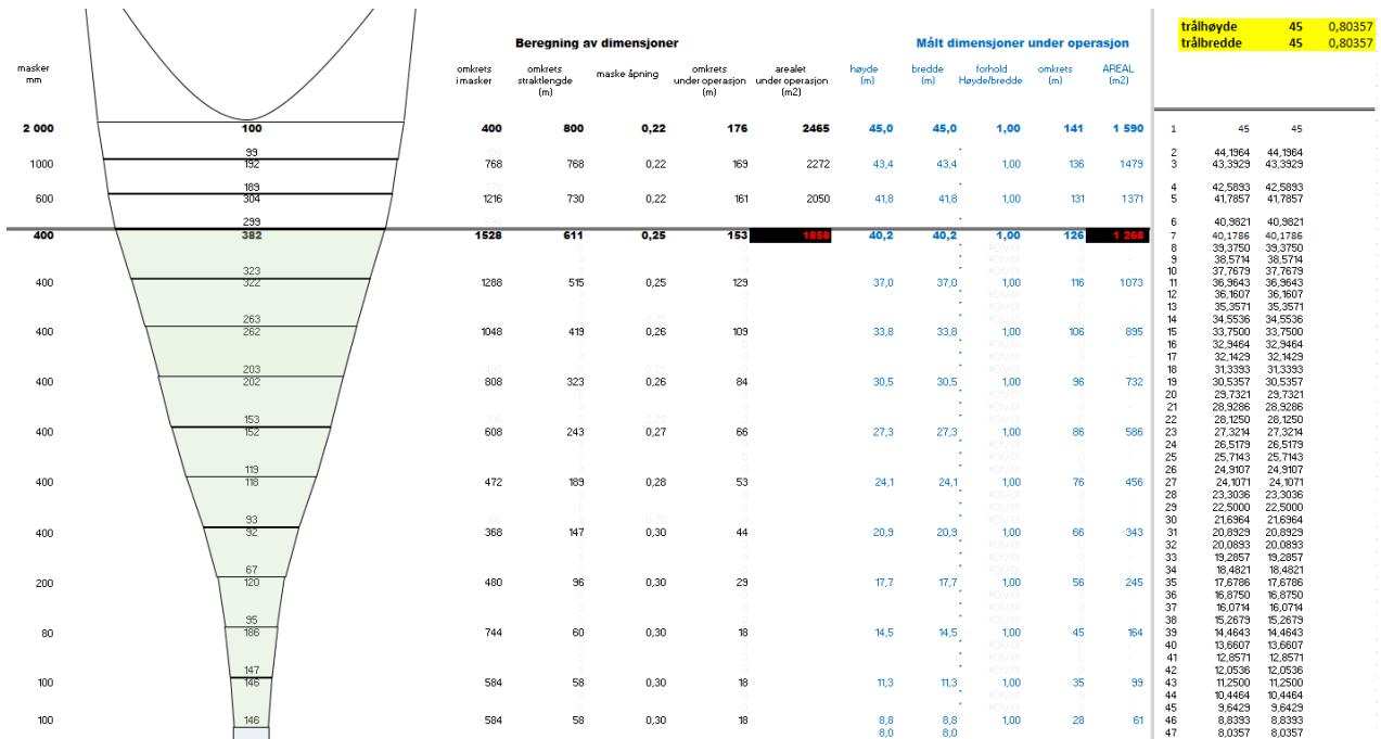
Figur 2. Beregning av tråldimensjoner og målte tråldimensjoner under operasjon for 800 m Lysprykkfisktrål.
