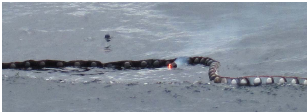
Figur 2.2 Umiddelbart etter at Pyrodrone har droppet ignitor-boksen på oljeflaket (Oseberg).
