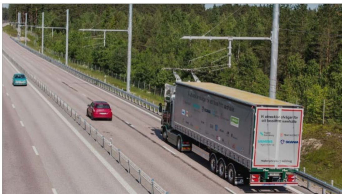
Figur 3. Scania lastebil med dieselhybrid og pantograf. (Foto: Scania)
