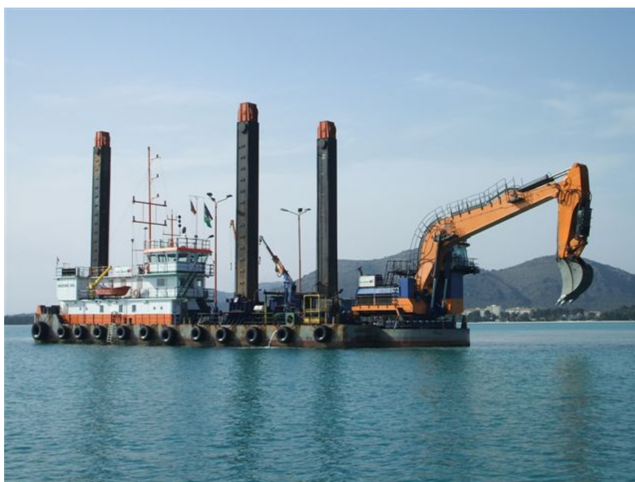
Figur 2.1 Bilde av mudring med en typisk bakgraver.
