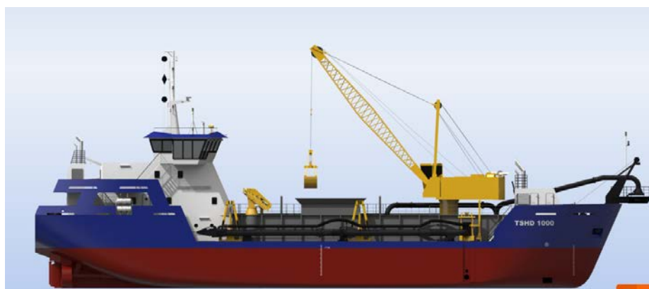
Figur 2.2 Bilde av mudring med en typisk kran med grabb i wire.
