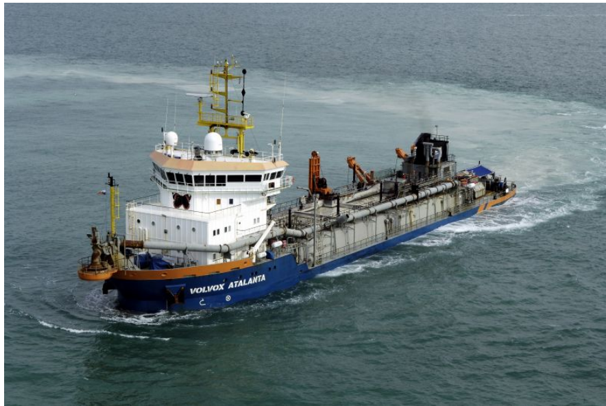
Figur 2.3 Bilde av mudring med en typisk sugemudrer.
