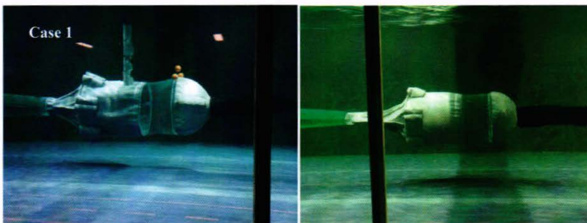
Figur 7. Case 1 til venstre, og tilsvarende pose med lang innløpskonus til høyre (Seksjon 1b). Den effektive konusvinkelen kan ses å være nokså lik for begge.
