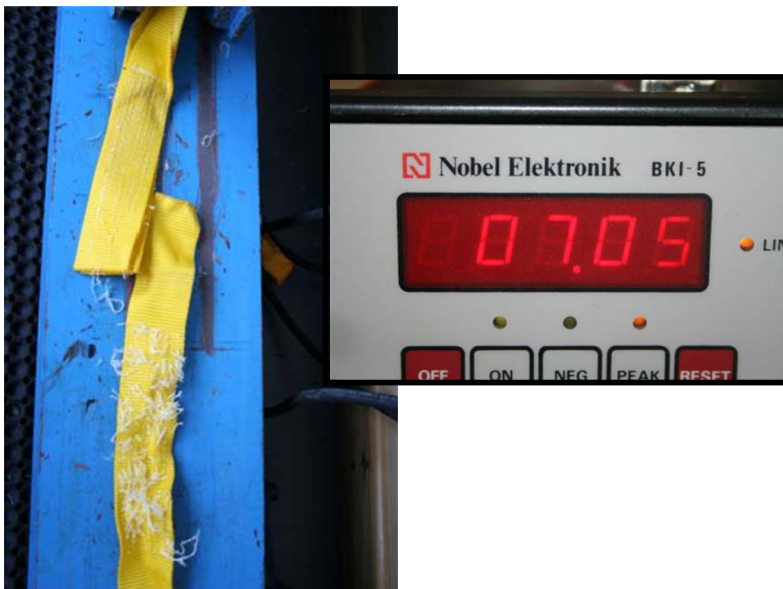
Figur 24. Strekktest av flatstropp.
