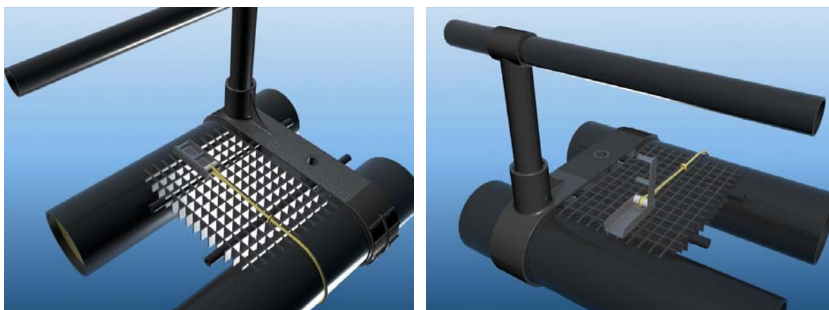
Figur 15. Universallås for innspenning av flatstropp.
