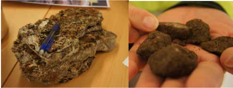
Figur 4 Eksempel på porøs bergmasse og knusningsmateriale fra breksjesonen
