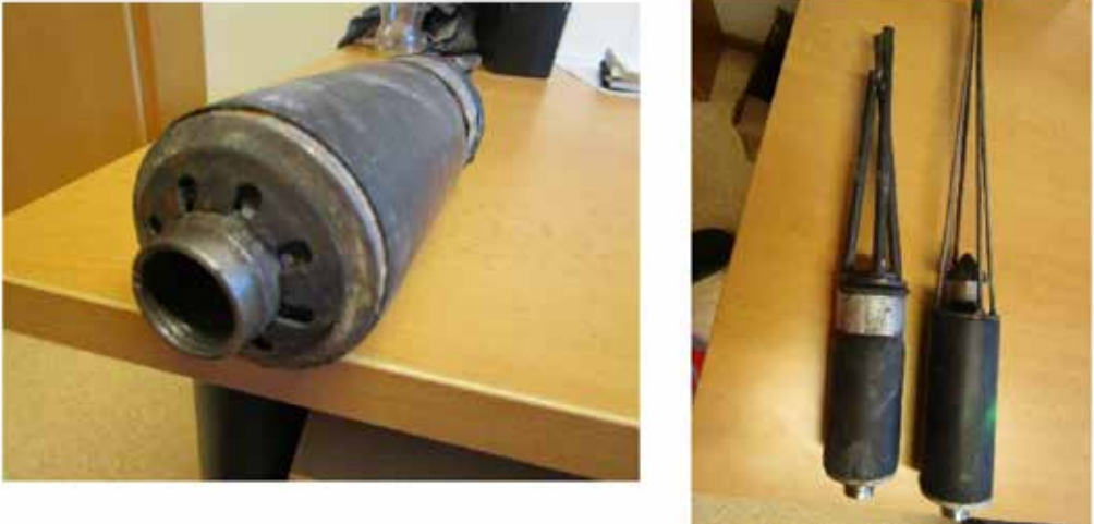
Figur 8 Forsterka låsing av gummi på pakker til venstre og påsveisa styrepinner til høyre.
