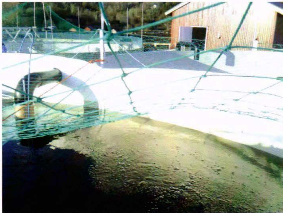
Figur 1. SOLVOX ® OxyStream montert i ø12m oppdrettskar hos Lerøy Midnor Lensvika, oktober 2009, her under testing med ferskvann
