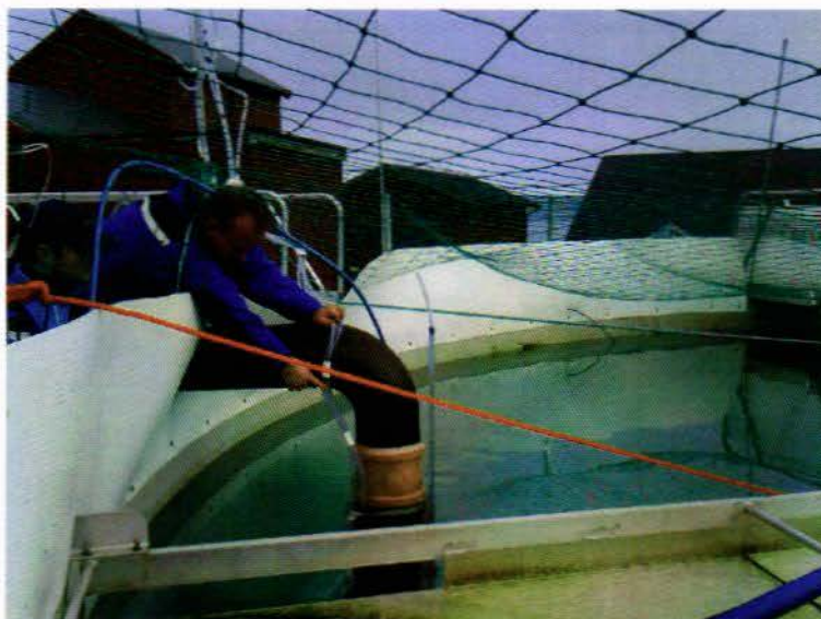
Figur 4. Registrering av dynamisk trykk i SOLVOX ® OxyStream
