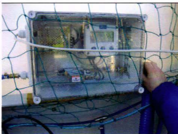
Figur 5. Dosert mengde oksygen ble registrert med et elektronisk flow-meter
