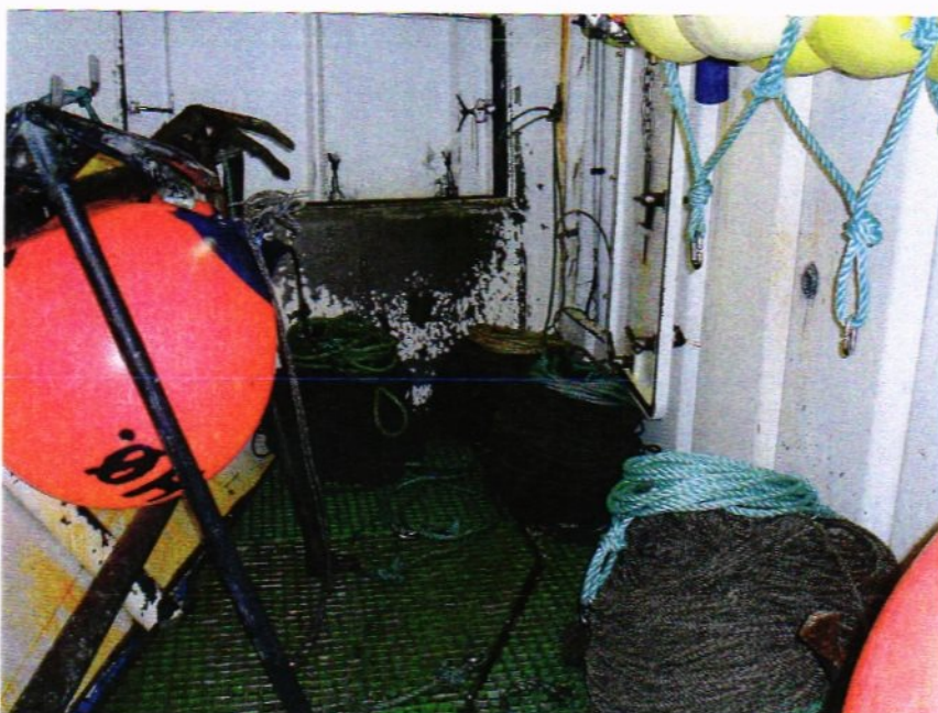
Bilde 6: Rom for setting av iler, hvor person har blitt fast og dratt over bord
