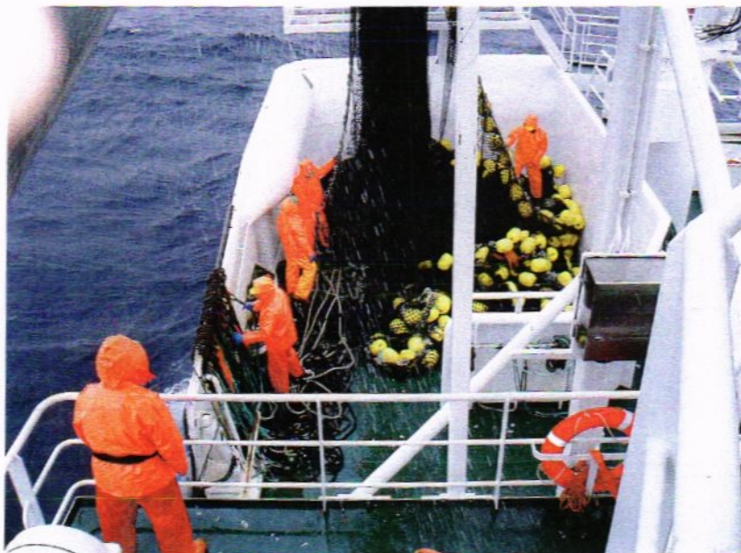
Bilde 14: Fjernstyring av kran (svart belte) ved legging av not i notbingen
