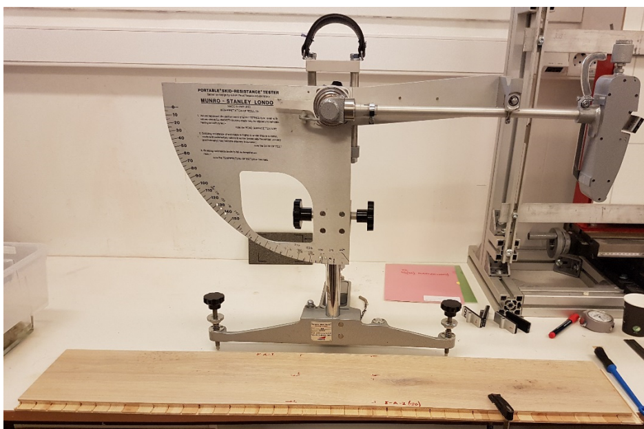
Bilde 10. Pendelprøveapparatet som ble brukt til prøvingen. Rød pil viser "slidern"
