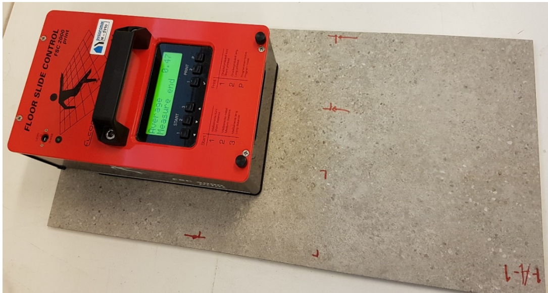
Bilde 11. Tribometerprøving med FSC 2000 på prøve 1.
