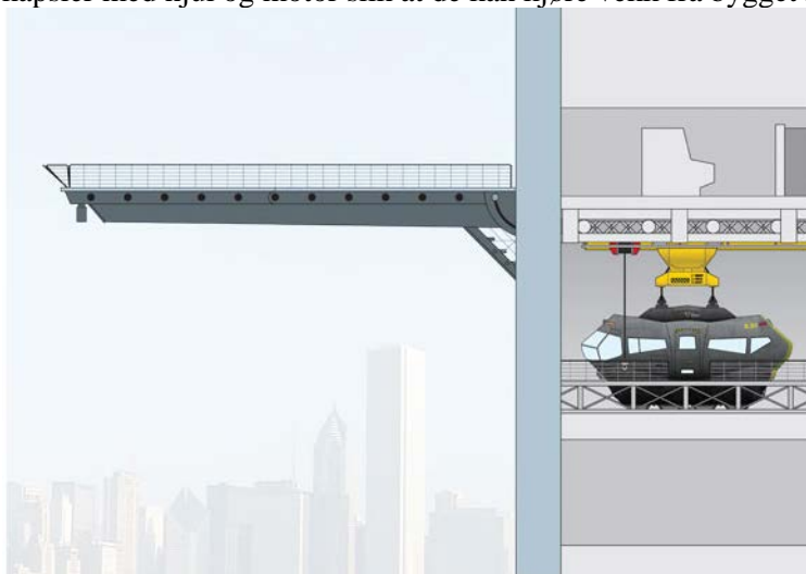
Figur 3. Redningskapsel med hjul stasjonert i sikker etasje. En bom felles ut og kapselen fires ned på utsiden av bygget.
