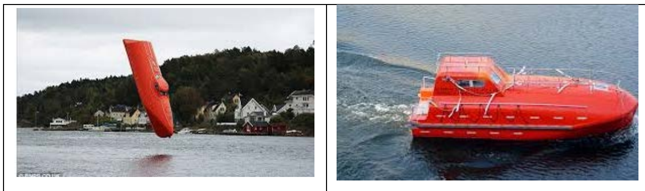
Figur 18. Fritt fall: Et Norsk båtbyggerfirma har verdensrekorden for det lengste fall en marin rømnings kapsel kan trygt tåle. GES50 falt 61.53 meter
