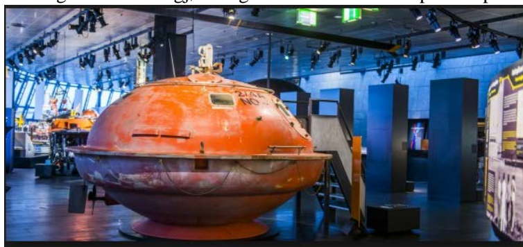
Figur 17. Rednings kapsler som "Whittaker lifeboat capsule" er og har vært anvendt offshore. De inneholder mat, vann og rom for 28 personer. Foto norsk oljemuseum
