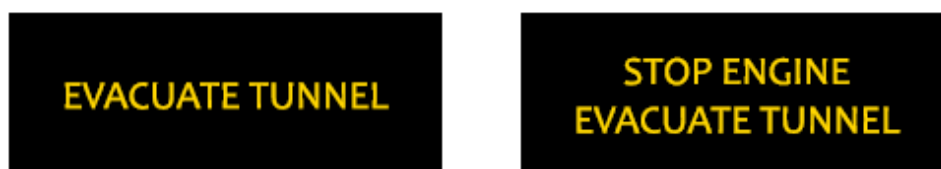
Figur 9. Skisse av skilt brukt i Gøta tunnelen i Sverige for å få trafikanter til å forlate sine kjøretøy og rømme tunnelen. Hentet fra Nilson et al 2017.
