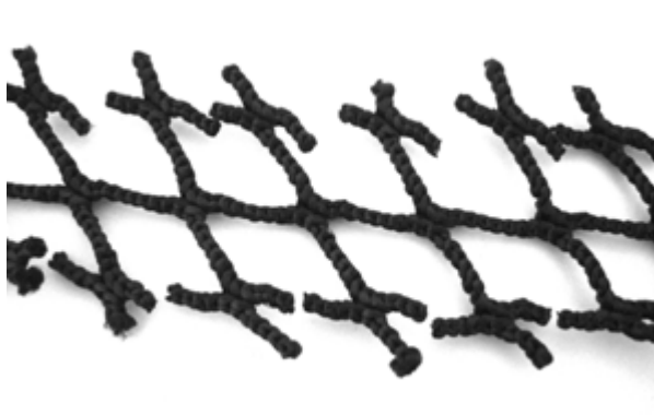
Figur 8 Form på prøve brukt i styrketest.
