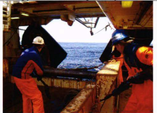
Innsjalling av sveiper ved utsetting av trålen
