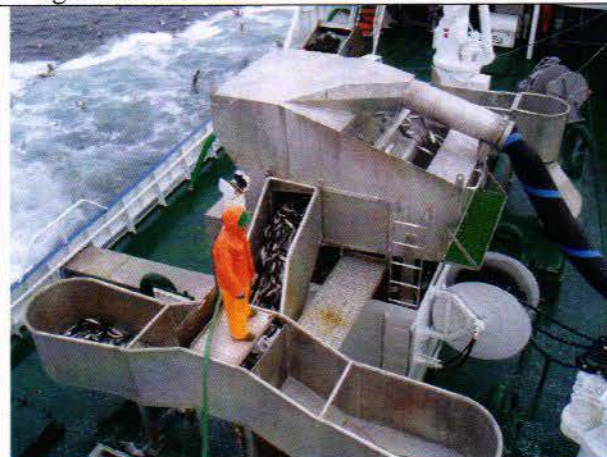
Sildefangsten pumpes om bord i RSW-tanker
