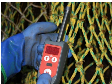
Figur 12: Maskevidde måling ved bruk av OMEGA gauge, her på Exit Windows sekk.
