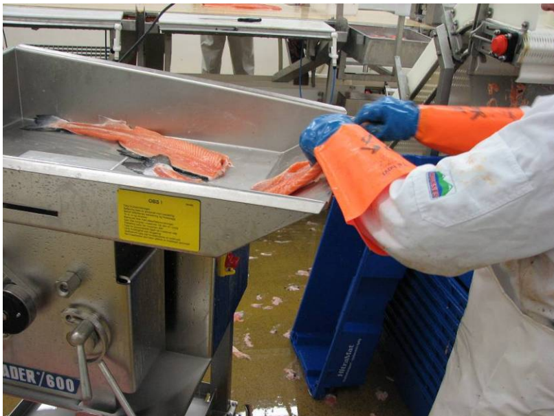
Figur 2. Innmating av separator. Større ansamlinger av blodrand ved nakke ble fjernet samtidig med innmatingen.
