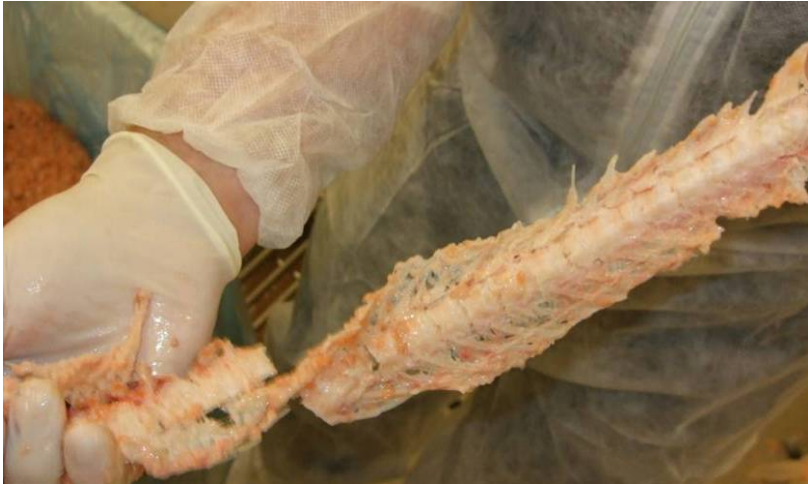
Figur 16. Høyt separasjonstrykk gav minimalt med restkjøtt på beinet etter separering.
