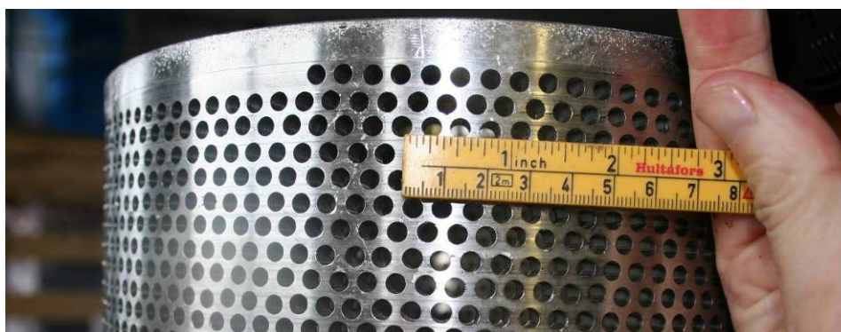
Figur 7. Trommel i Baader 600 båndseparator med 5mm hulldiameter brukt til prøveproduksjon 22. oktober 2007.
