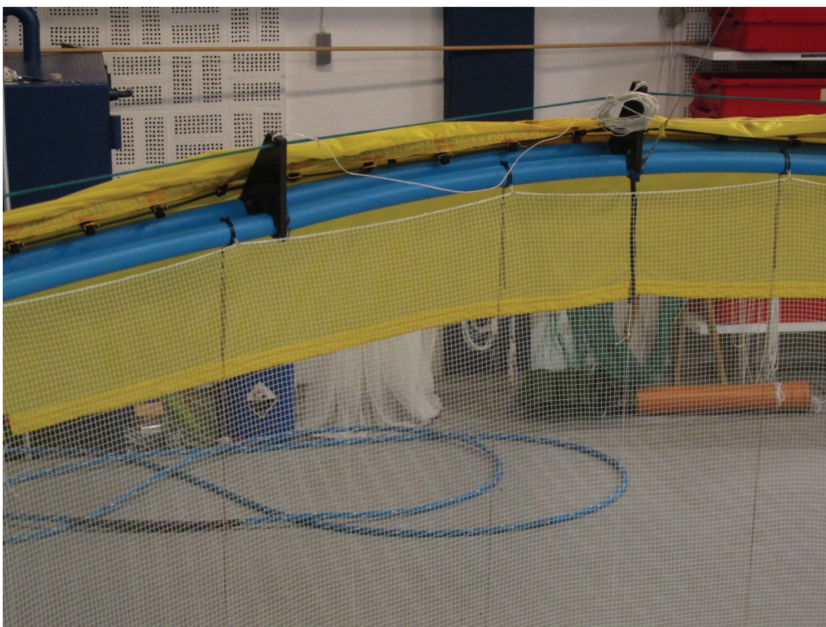
Fig. 3.2.1 Modellmerd med to flyteringer i PE80, nylonnot med soliditet 21%, og permaskjørt av fallskjermduk.
