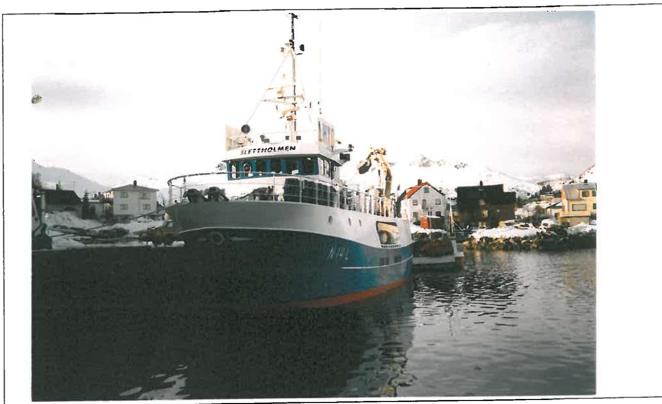
Bilde 3 : Kystfiskebåten M/S "Slettholmen" N-14-L fra Lurøy, aluminium, Loa = 67 fot, ved verksted i Svolvev, mars 1997, bygget i 1996 ved Jakobsen Mek. Verksted AS, Slenseset i Lurøy..
