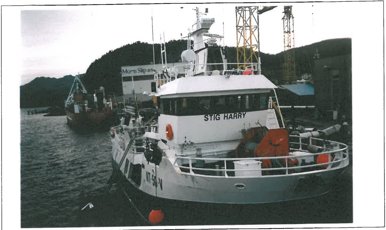
Bilde 5 : M/S "Stig Harry" NT-50-V (SH nr. 3) fra Rørvik i Vikna, 70-fots kombinasjonsbåt av Solnes-design, bygget i aluminium ved Moen Slip i 1998 og rigget for kystfiske med not og garn.
