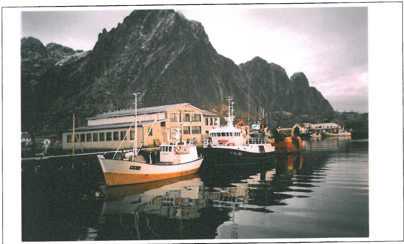
Bilde 2 : Fiskebåter bygget av tre/aluminium (foran), aluminium (”Havlys” i midten) eller stål (småtråler bakerst) ved verksted i Svolvær, bla. M/S ”Havlys” H-40-ØN, Mjosundbåt fra 1997.
