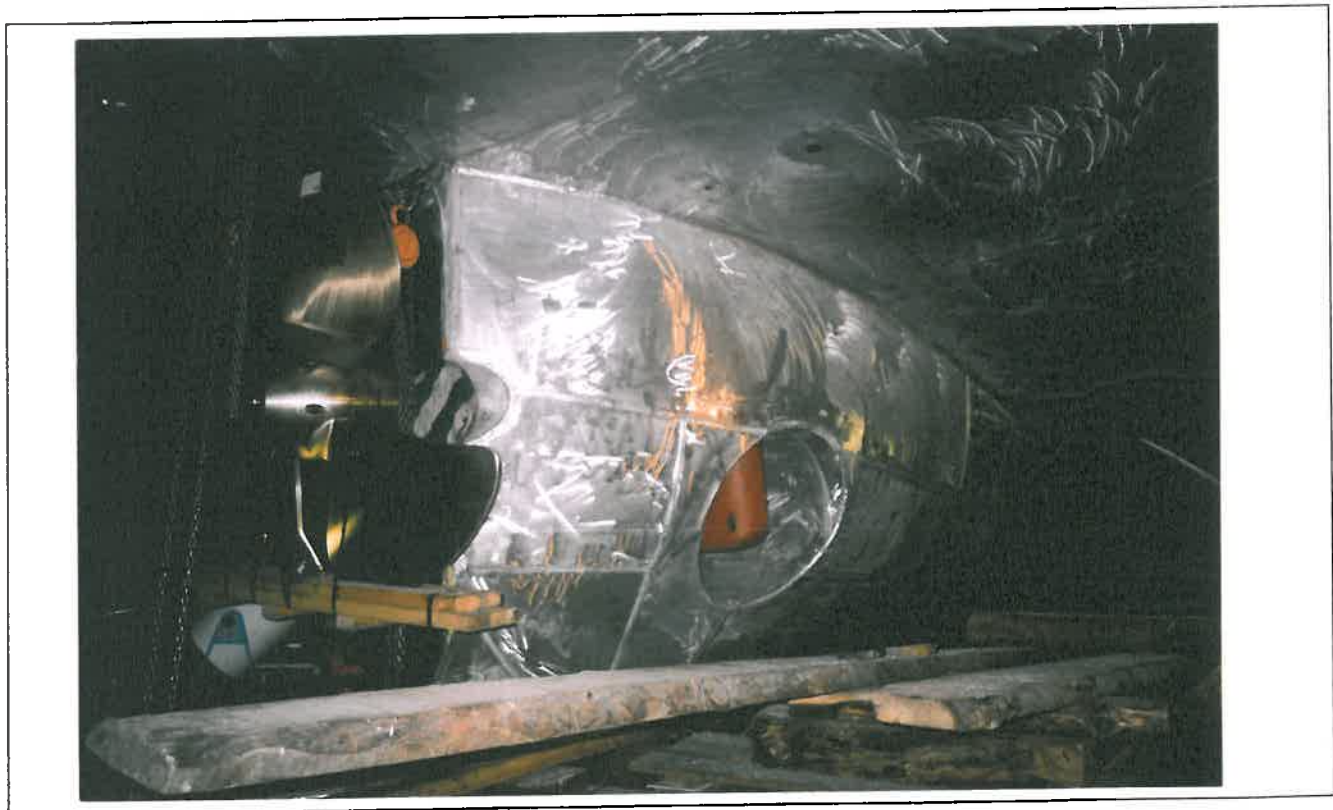
Bilde 14: Kystfiskebåten "Korsnesfisk" av Båtsfjord under bygging ved Saltdalsverftet, des. 1998. Detaljer fra undervanns akterskip med hovedpropeller og aktre sidepropeller med hus av støpejern.
