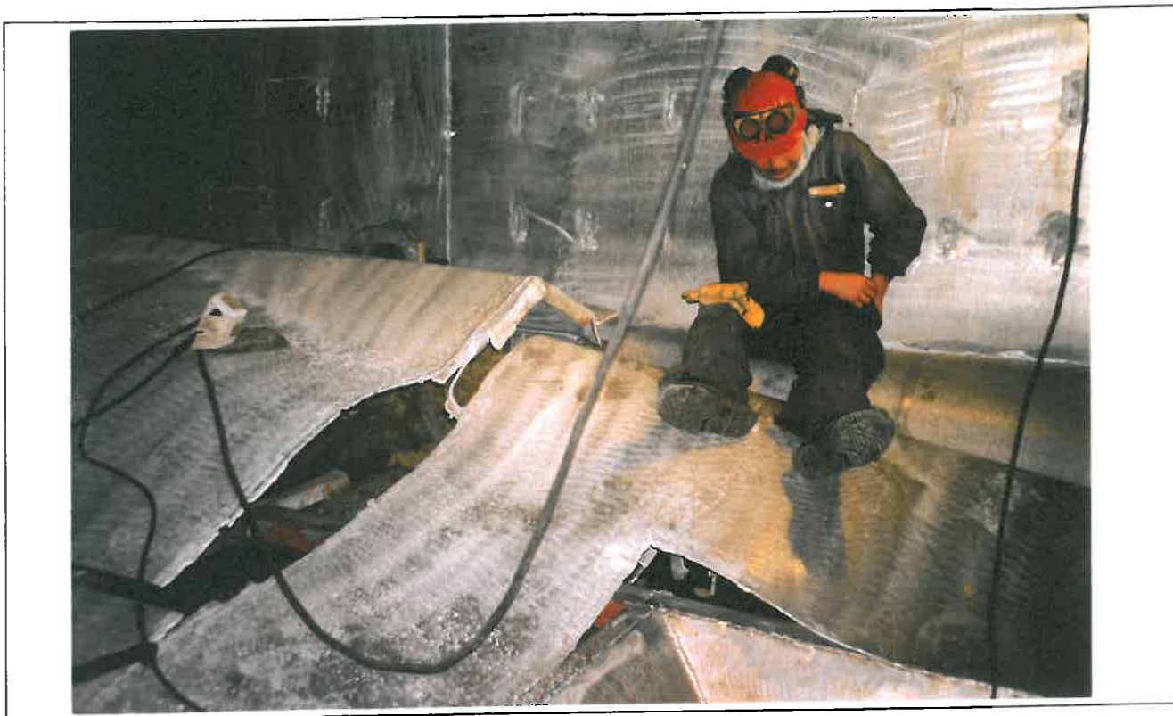
Bilde 15: Skader på garneringen i bulkrom på M/S "Solværgutt" N-12-A, etter en eksplosjon under reparasjonsarbeid i Grovfjord i mai 1999. Bygg nr. 60, Skogsøy Båtbyggeri AS, Mandal, nov. 1998.
