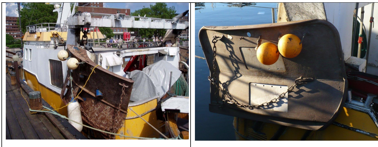
Bilde 9 Tråldører for fjordtråling etter reke i Oslofjorden / Sør-Norge.
